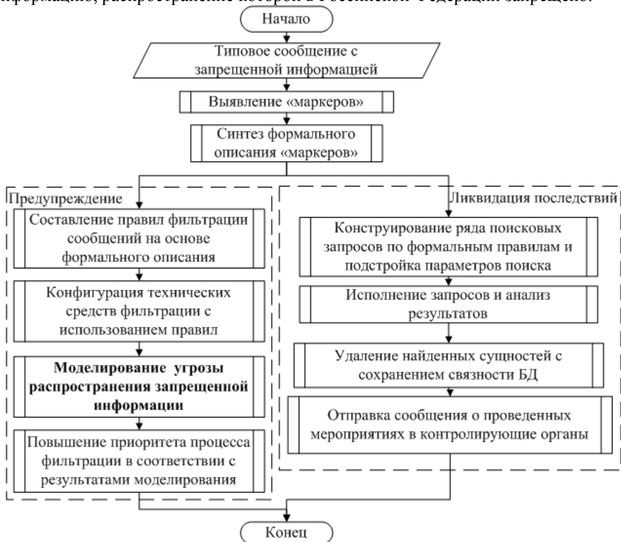
Рисунок 6 – Обобщенный алгоритм противодействия распространению угрозы запрещенной информации
