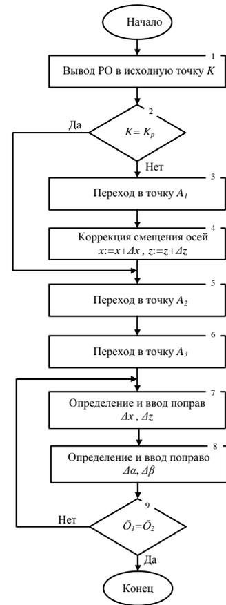
Рисунок 6 - Блок-схема алгоритма согласования осей
