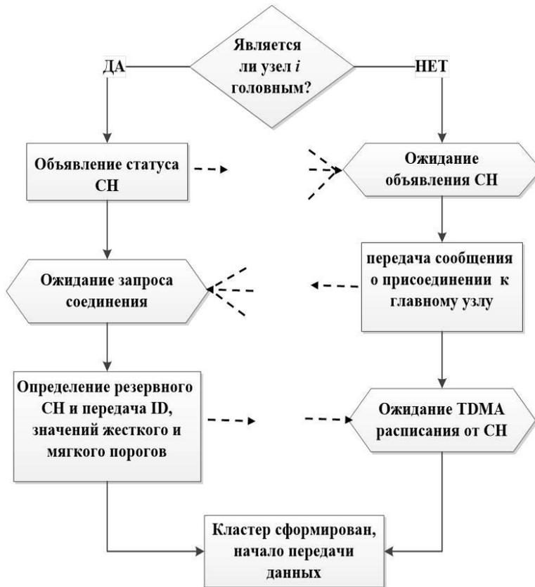
Рис. 4 – Блок-схема формирования кластера для разработанного алгоритма
