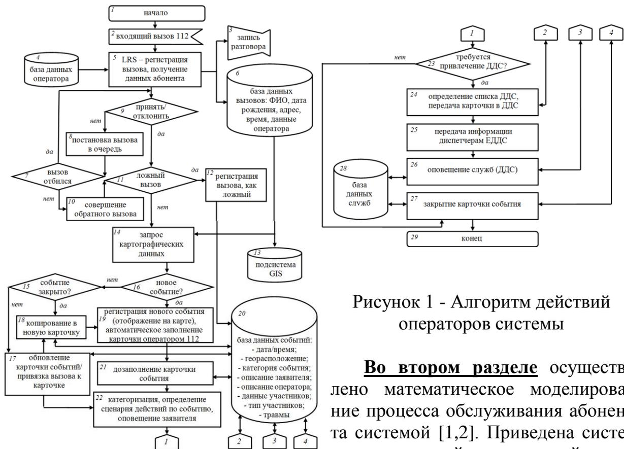
Рисунок 1 - Алгоритм действий операторов системы
