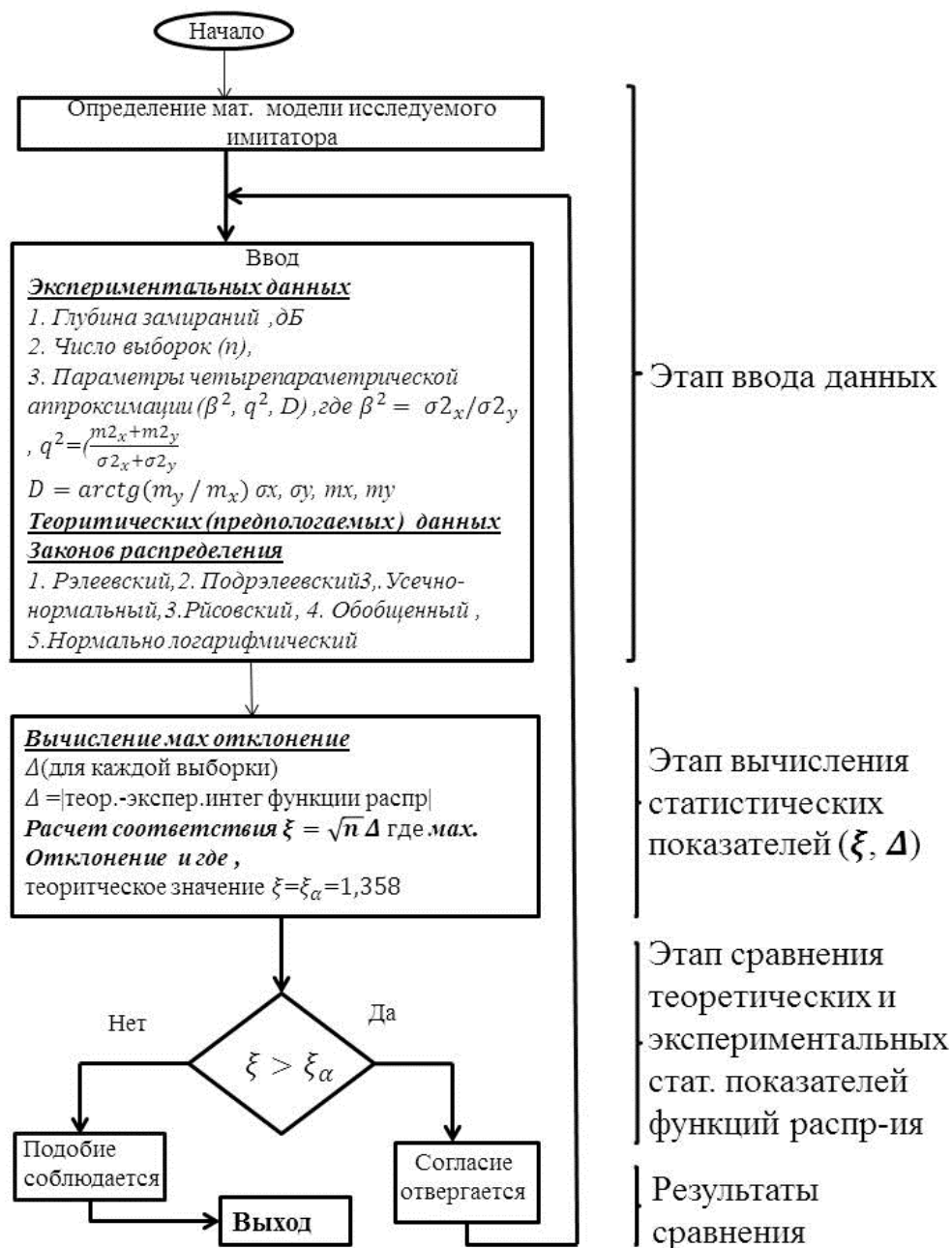
Рисунок 8. Упрощенный алгоритм оценки адекватности ИРКПИ реальным каналам связи
