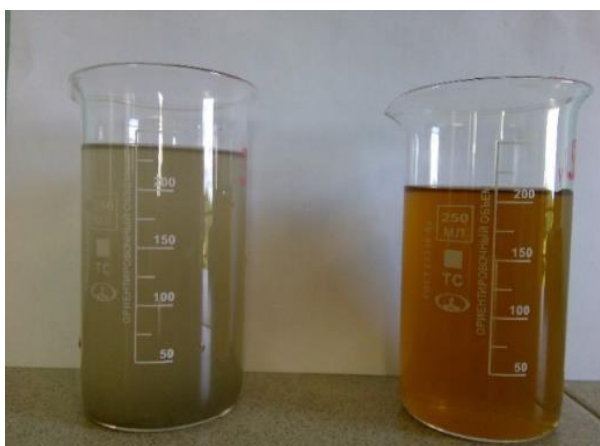
Рис. 3 – Муниципальные сточные воды г. Владимира до (слева) и после прохождения вермифильтра (справа).
