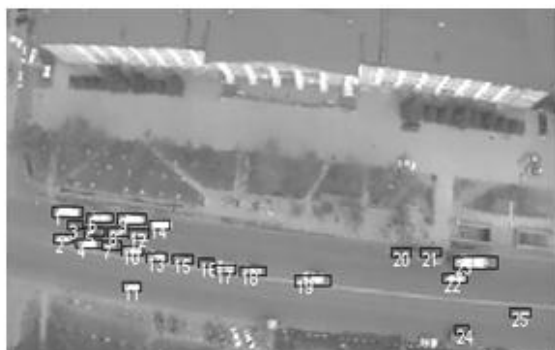
Рисунок 7. Погрешность по количеству автомобилей, вносимая шумовым фоном: а) – пример зашумлённого изображения; б) – аппроксимация погрешности по количеству автомобилей в зависимости от отношения сигнал-шум в тракте приёмного устройства
