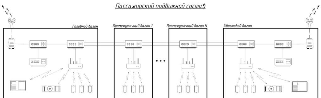
Рисунок 2 – Схема локальной сети Wi-Fi поезда
