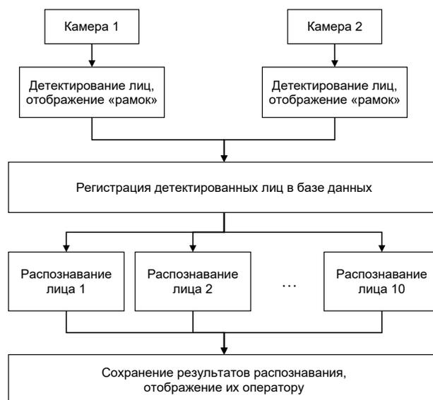
Рисунок 12 - Схема функционирования программного обеспечения в ходе испытаний.
