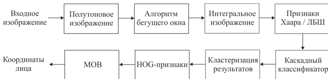
Рис. 5. Схема алгоритма с постклассификацией на основе НОГ-признаков
