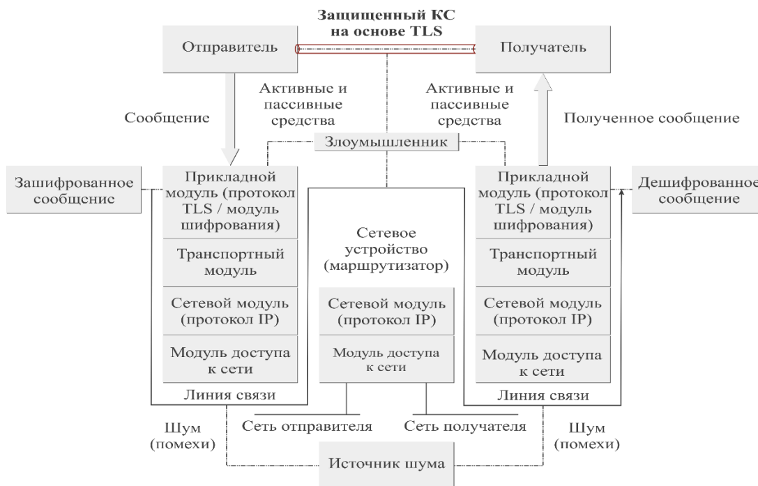
Рисунок 1 – Структурная схема канала связи сети TCP/IP
