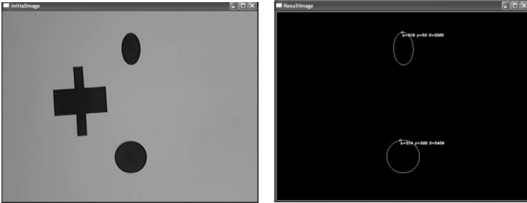
Рисунок 8 – Поиск объектов на сцене видеоизображения с посторонними объектами: слева – исходная сцена; справа – обнаруженные объекты интереса
