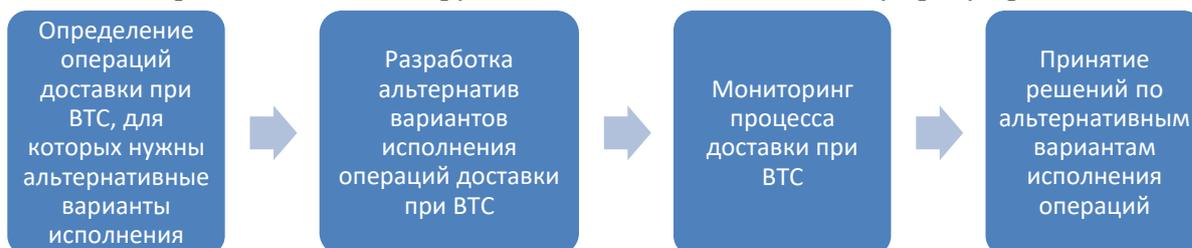
Рисунок 4 – Алгоритм принятия альтернативных решений по операциям ВТС для обеспечения ДТНС
