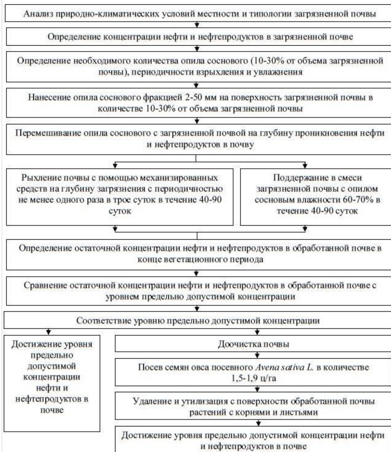
Рисунок 11 – Технология очистки почв от нефти и нефтепродуктов
