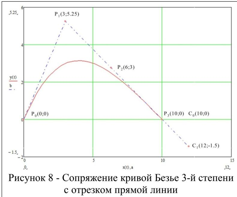
Рисунок 8 - Сопряжение кривой Безье 3-й степени с отрезком прямой линии
