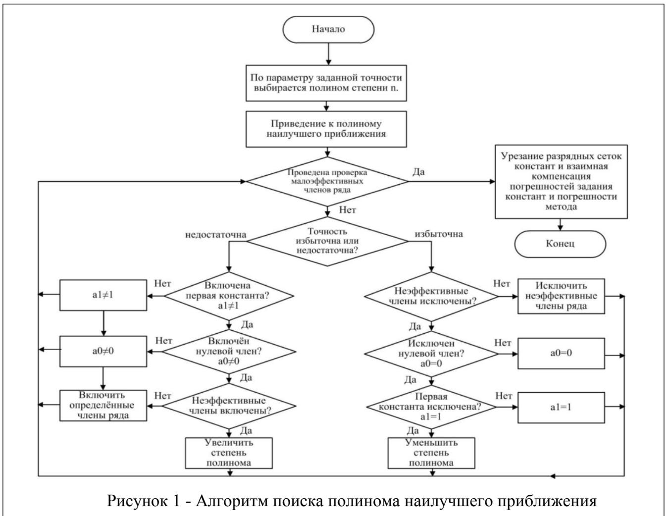
По описанному алгоритму при помощи разработанной программы на языке Builder C++ были найдены полиномы наилучшего приближения различных степеней для аппроксимации функций  $\sin(x)$  на интервале  $x \in [0; 1,571]$  и  $\sqrt{x}$  на интервале аппроксимации  $x \in [0; 1]$ .
