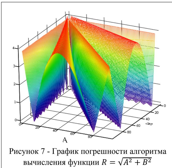
лучшего приближения на трех подинтервалах с примерно равными абсолютными максимальными значениями погрешностей. Измерение фазы с использованием предварительно определенных подинтервалов аппроксимации вычисления амплитуды сигнала по ортогональным составляющим обеспечивает уменьшение погрешности примерно в 10 раз при фиксированных остальных критериях вычислительного процесса (рисунок 7). Разрабо-
