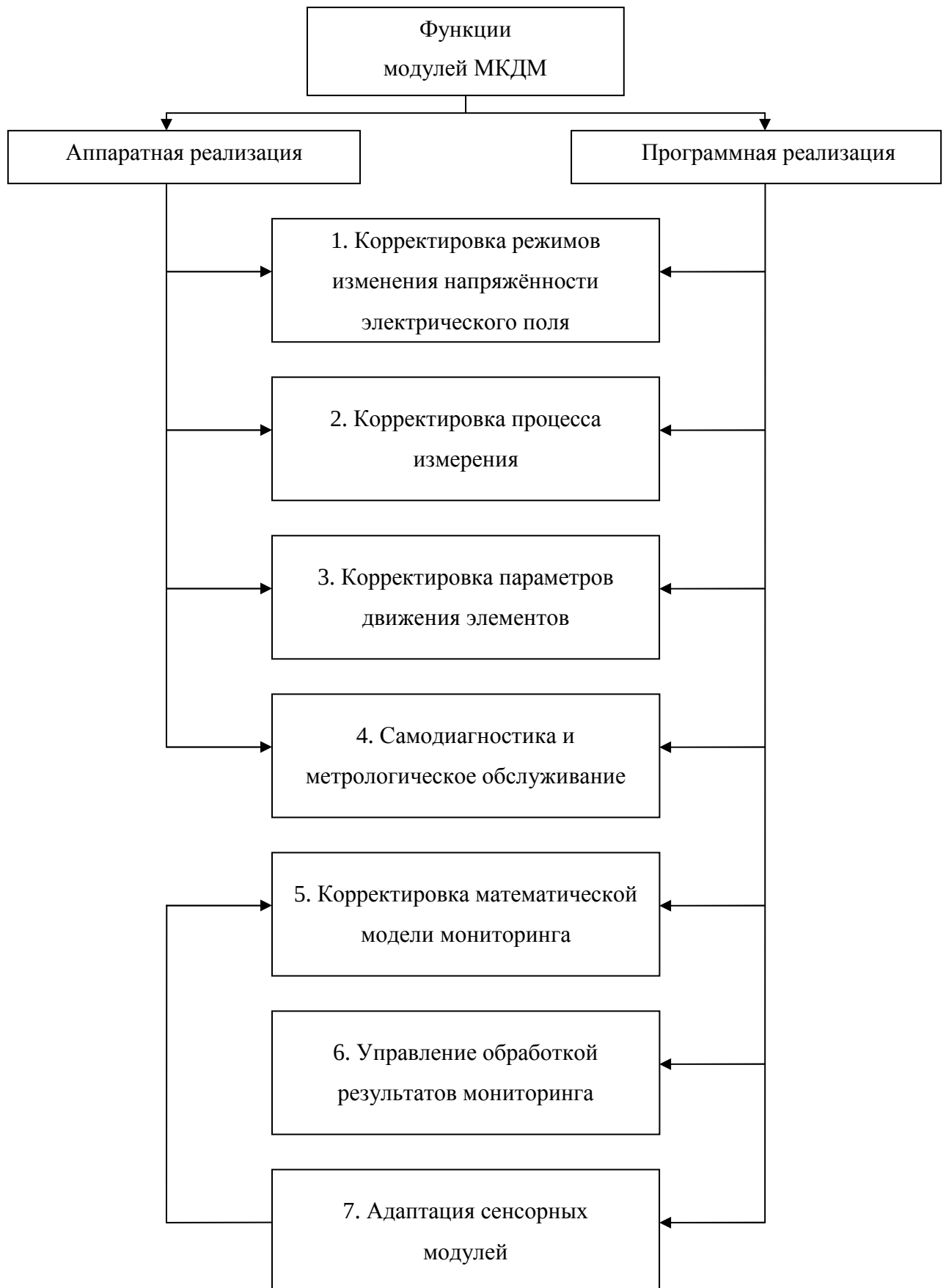
Рис. 3.2. Структура и взаимосвязи функций модулей мехатронного комплекса
