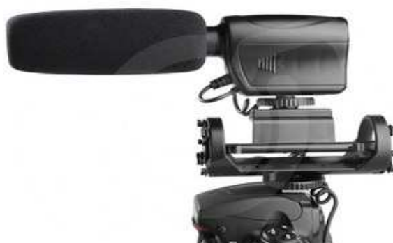
Рис. 1.4. Направленный микрофон «Raylabdirect-III», размещённый на манипуляторе
