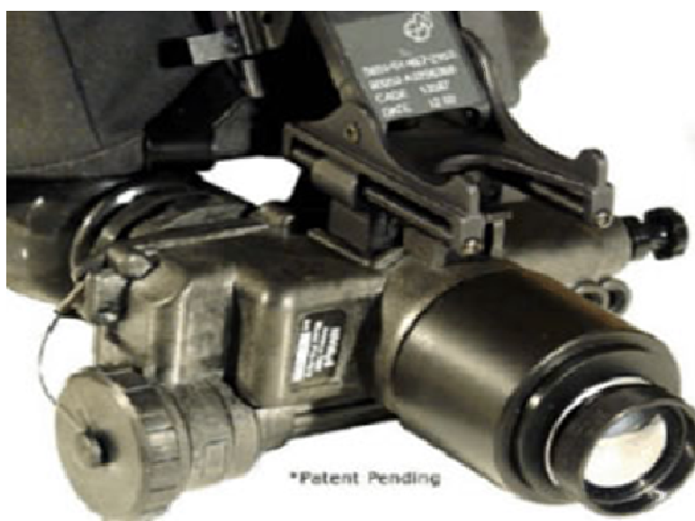
Рис. 1.2. Портативный тепловизор «Т7-Thermal», размещённый на манипуляторе
