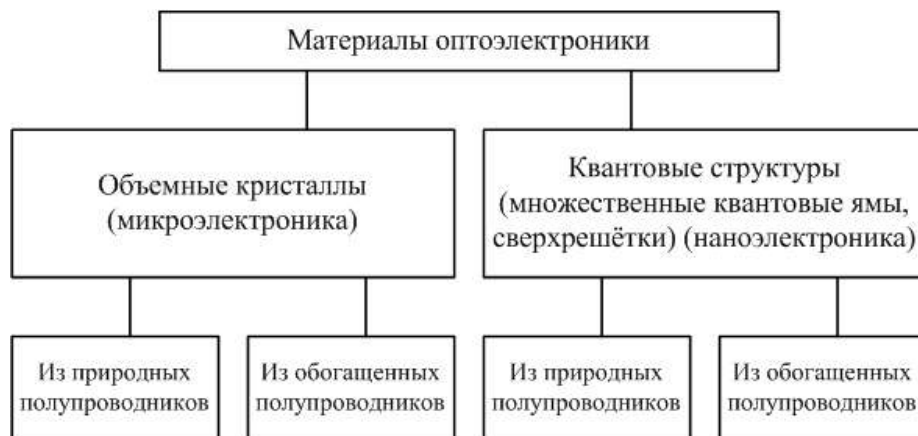
Рисунок 3.1 – Материалы оптоэлектроники на основе ОК и КЯ
