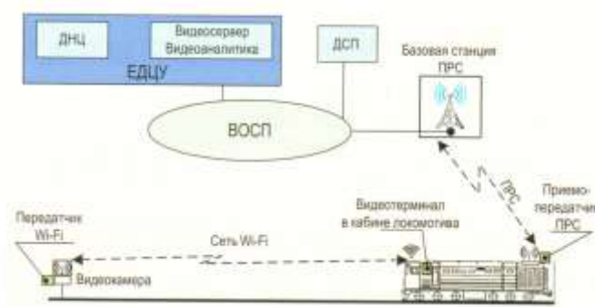
Рисунок 1.7 – Организация СИВ на основе сети Wi-Fi
