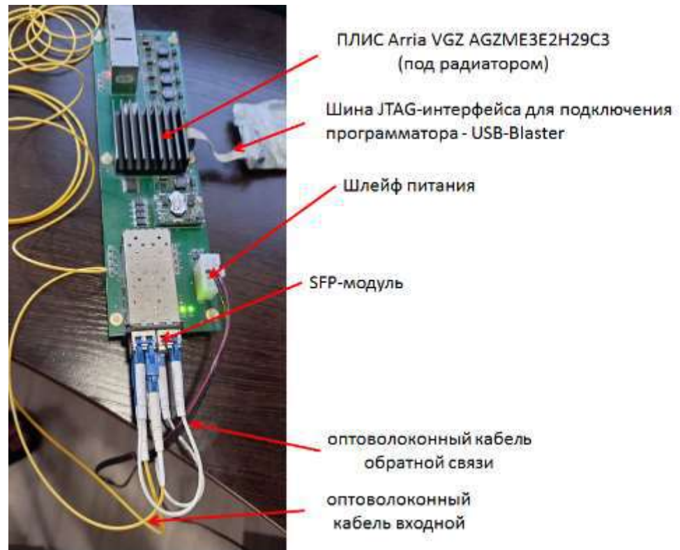
Рисунок 4.3 – Проверочный стенд алгоритма работы ПЛИС
