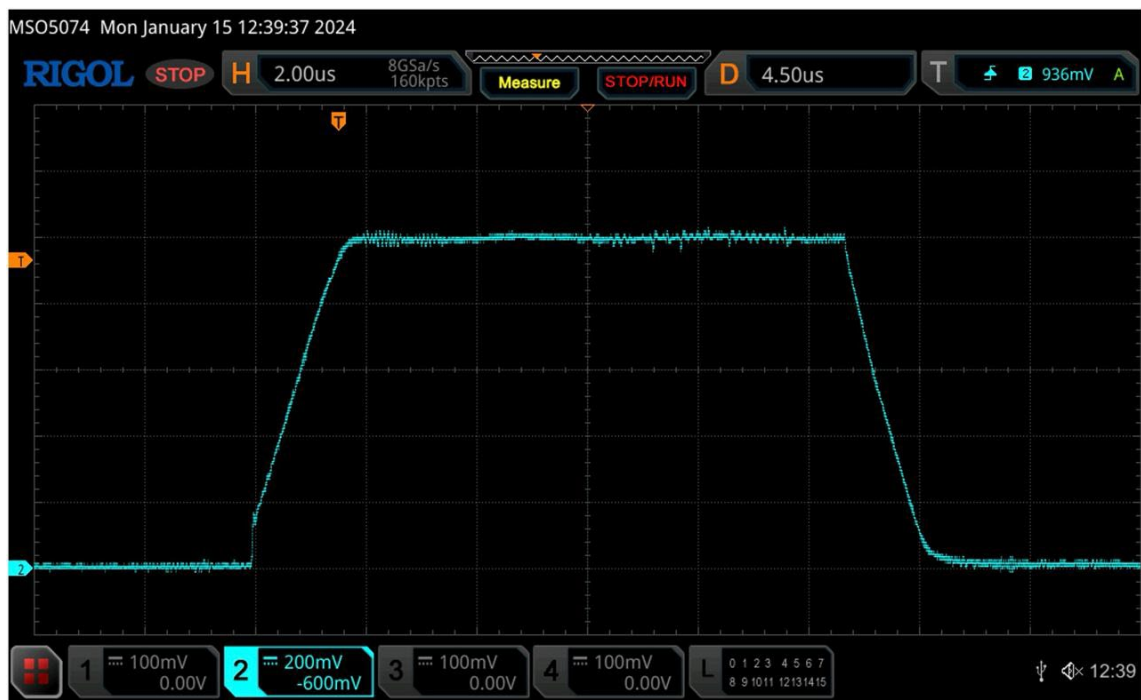
Рисунок 3.6 – Экранные изображения с осциллографа, демонстрирующие характеристики импульса «записи»
