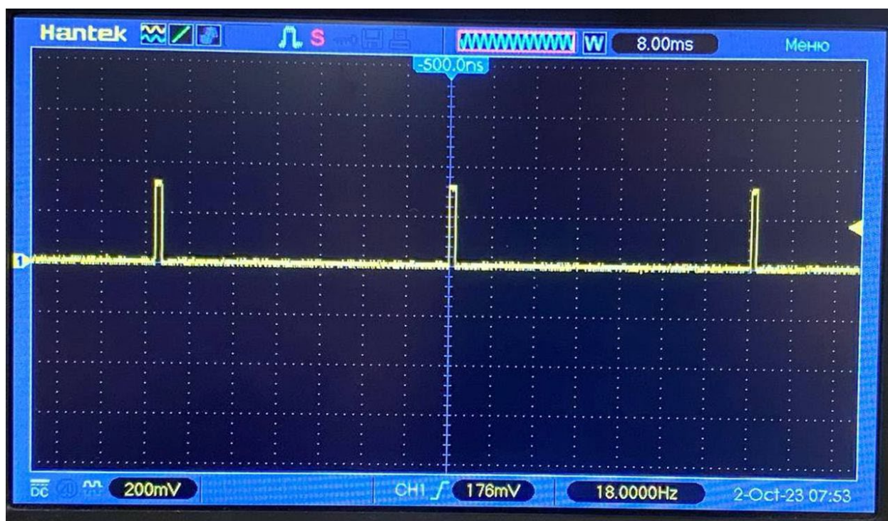
Рисунок 3.7 – Экранные изображения с осциллографа, демонстрирующие отправку сигнала «чтения» с максимально доступной для данного устройства частотой.
