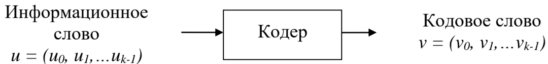
Рисунок 1.3. Кодер блочного кода
