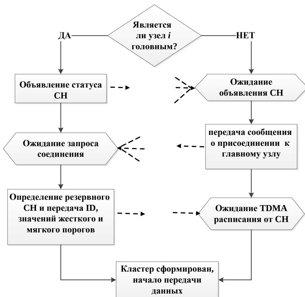
Рис. 4.4 – Блок-схема формирования кластера для разработанного алгоритма
