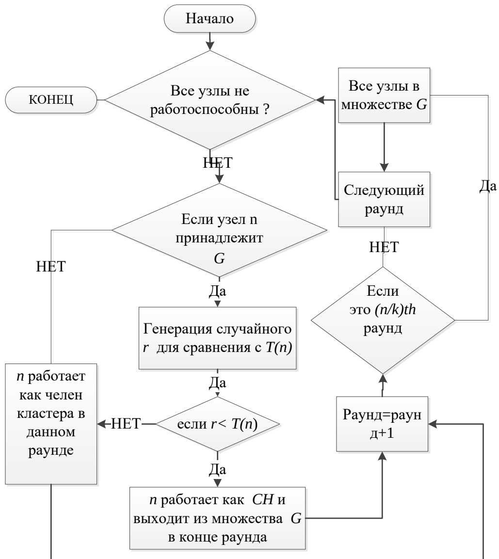
Рис. 2.5 – Блок-схема LEACH протокола
