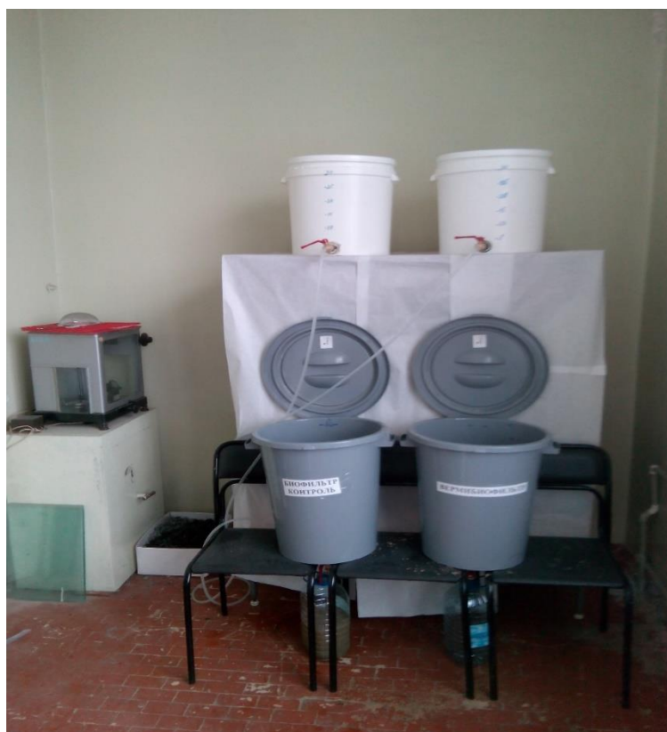
Рис. 16 – Лабораторные установки для очистки сточных вод. Слева контрольная без дождевых червей, справа – вермибиофильтр.
