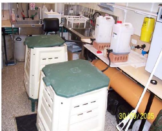
Рис. 2 – Лабораторная установка для вермифiltrации сточных вод с регулируемым потоком жидкости из канистры (Sinha, 2012).
