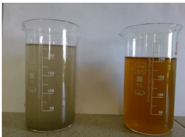
Рис.19 – Муниципальные сточные воды г. Владимира до (слева) и после прохождения вермифилтра (справа).
