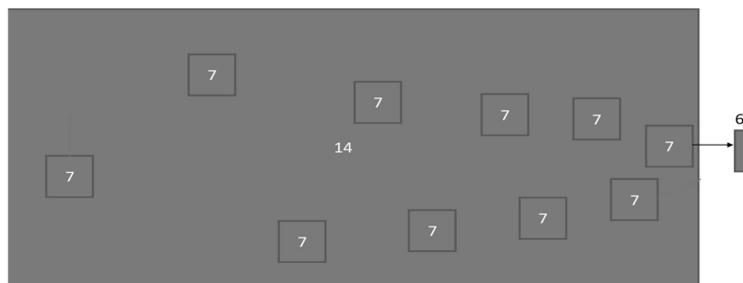
Рисунок 2.3 – Схема размещения узлов-датчиков в грузовом вагоне
