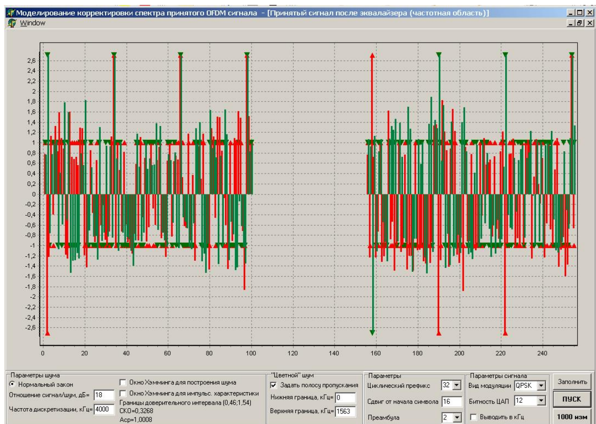
Рисунок 3.2.2 - Рабочее окно программы моделирования, принятый сигнал после эквалайзера
