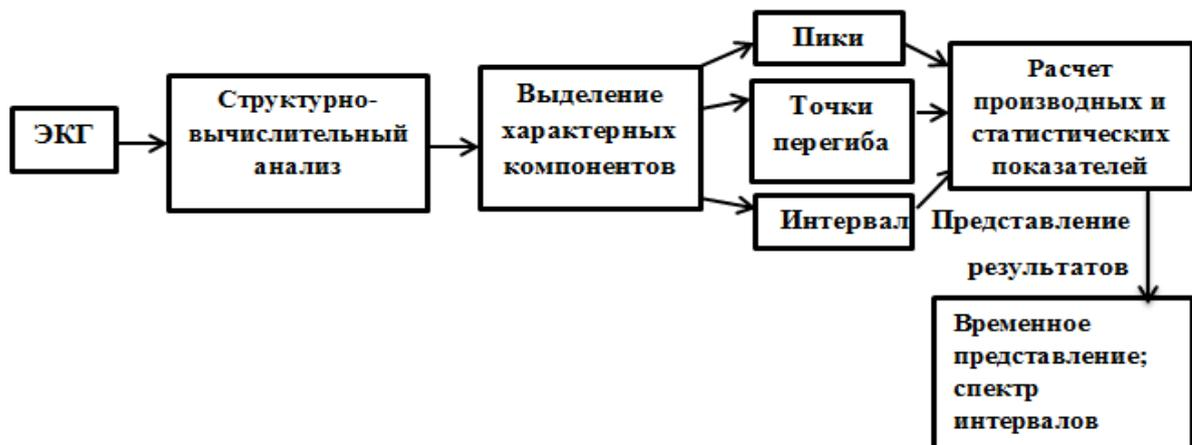
Рисунок 1.4 – Типовой алгоритм анализа ЭКС.
