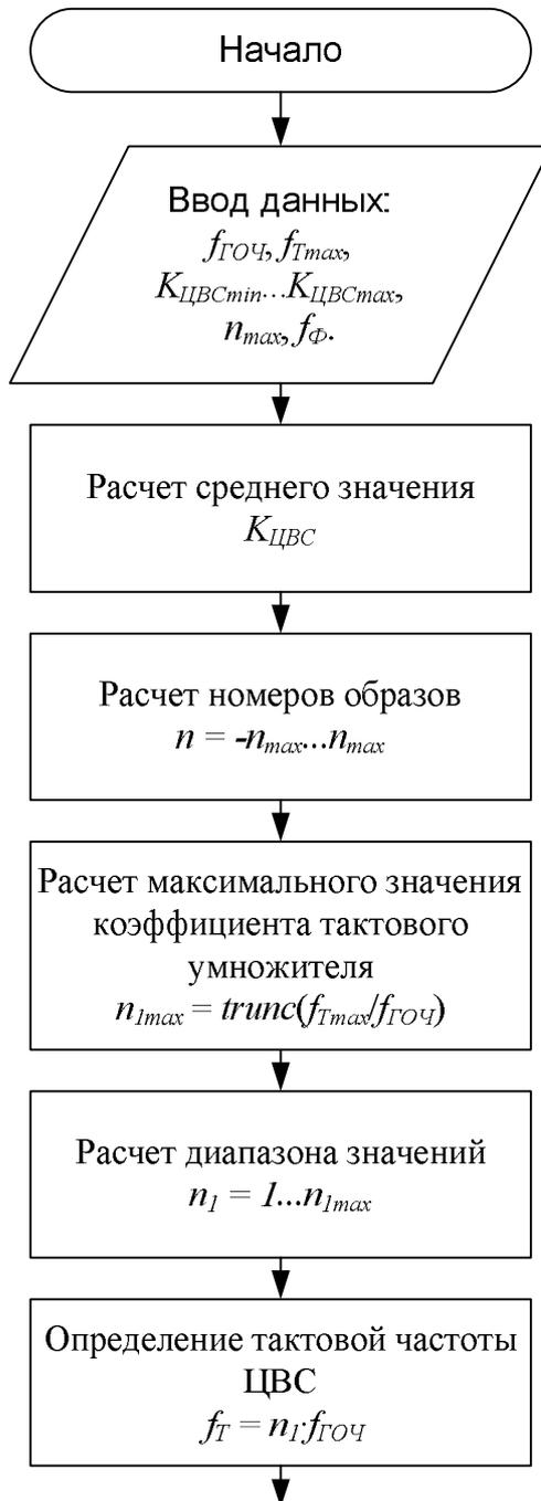
Рисунок 2.5.1 – Блок схема алгоритма частотного планирования формирователей сигналов на основе ЦВС с использованием образов его основной частоты
