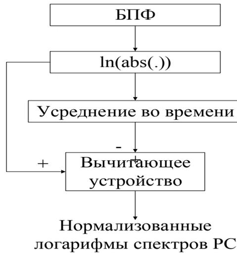
Рисунок 3.6. Обработка сигналов на входе и выходе фильтр-имитатора
