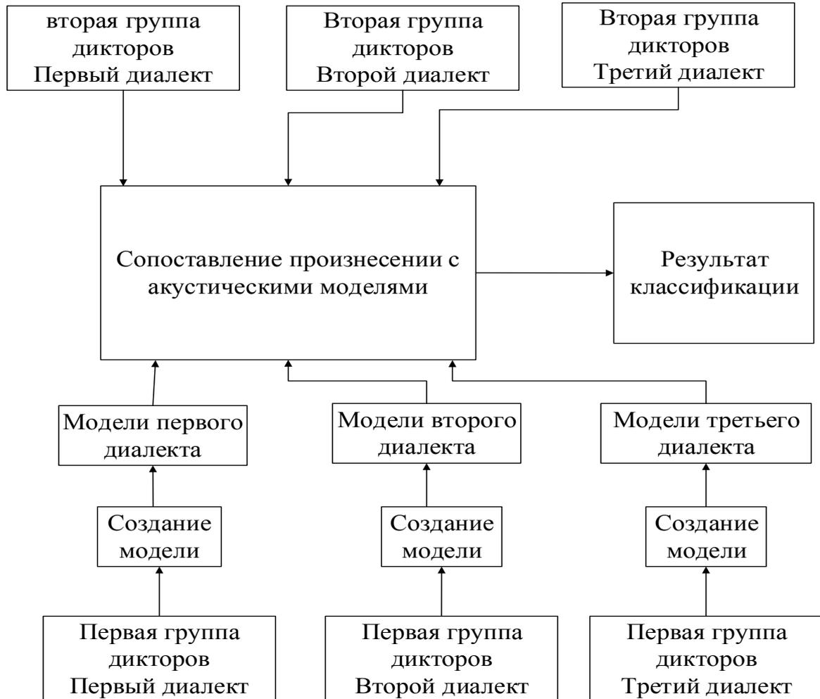
Рисунок 2.3. Алгоритм тестирования системы распознавания при использовании идентификации
