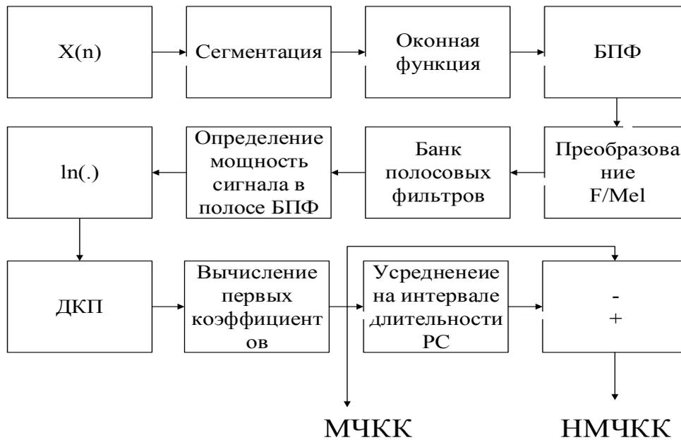
Рисунок 3.1 Схема обработки речевого сигнала при формировании МЧКК
