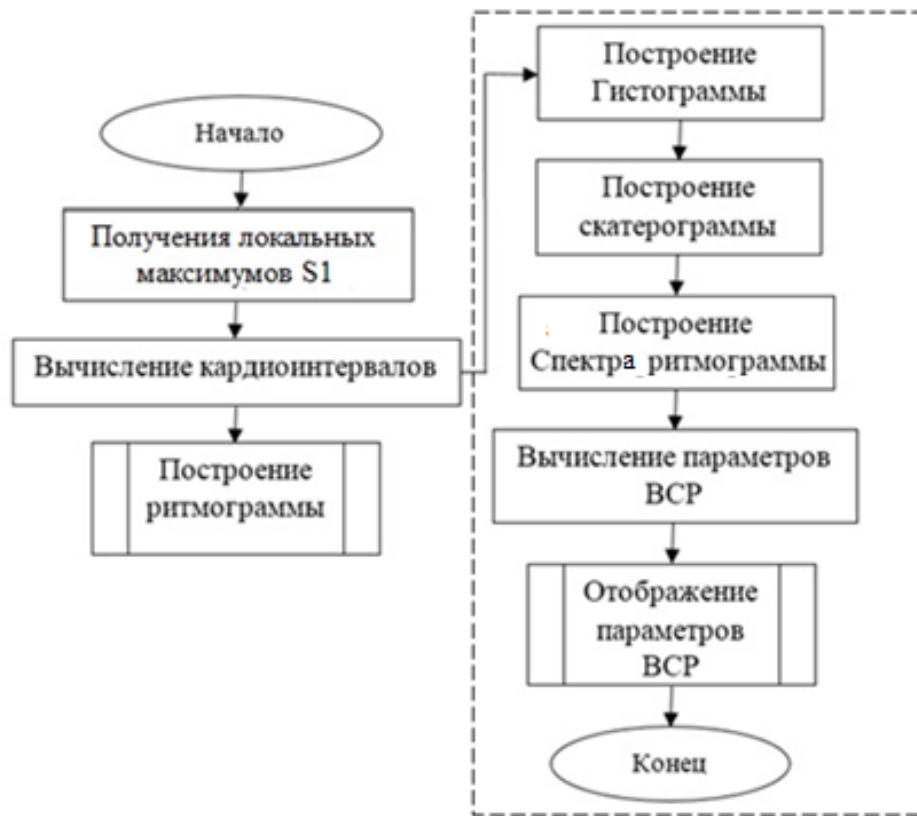
Рисунок 4.4.Блок-схема алгоритма вычисления и анализа КИГ и построения ритмограммы
