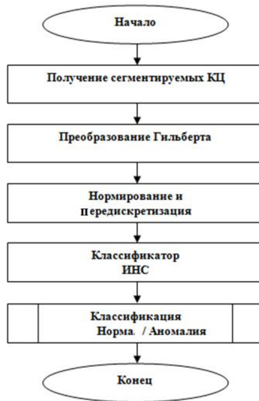
Рисунок 4.12 –Блок-схема алгоритма классификации ФКГ - сигналов.
