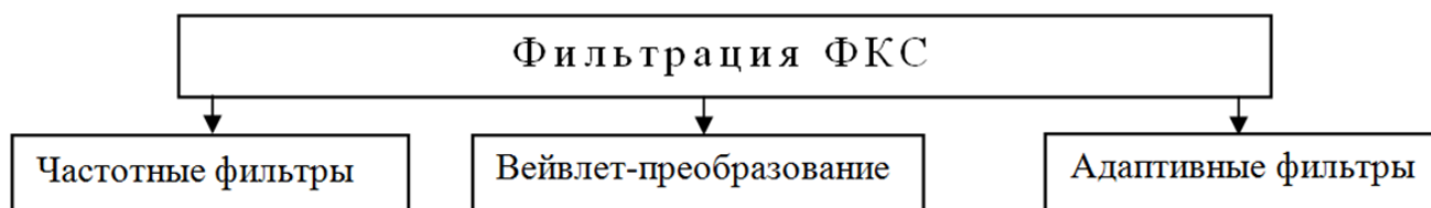
Рисунок 2.1. Классификация наиболее часто применяемых фильтров для подавления шума на ФКГ – сигнала
