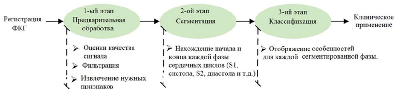
Рисунок 1.7. Основные этапы автоматизированной обработки и анализа электрокардиограмм.
