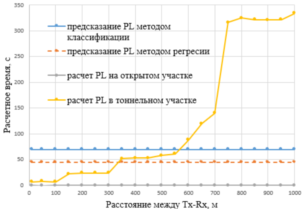
Рисунок 54 – Время расчета и предсказания PL в зависимости от расстояния между Tx-Rx с учетом времени обучения
