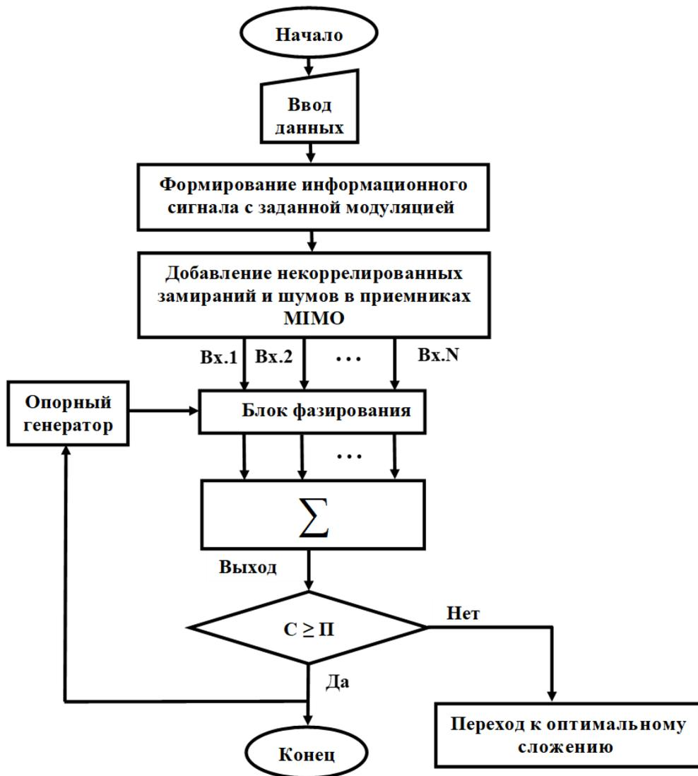
Рисунок 3.11. Структурная схема алгоритма сложения разнесенных сигналов по методу линейного сложение
