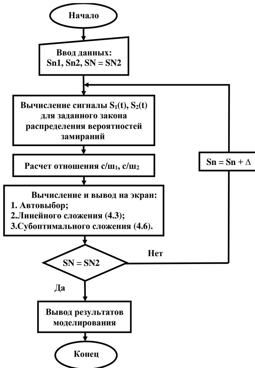
Рис. 4.19. Алгоритм сравнения методов обработки сигналов в системах ММО при различных законах распределения вероятностей замираний
