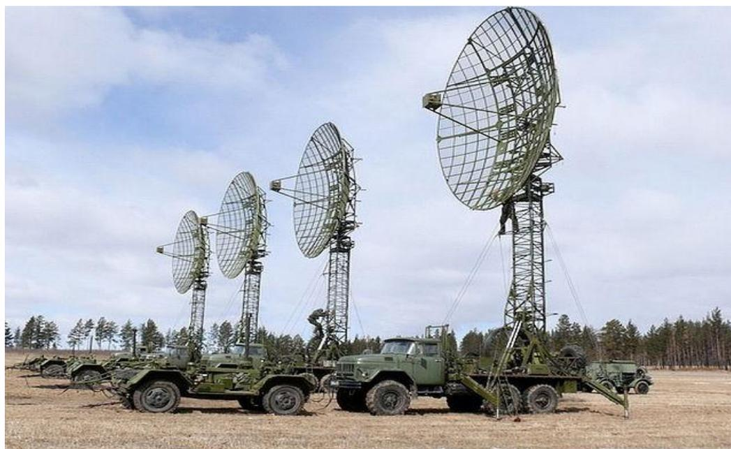
Рисунок 1.3. Радиостанции дальней тропосферной связи Р-410, использующие режим ММО
