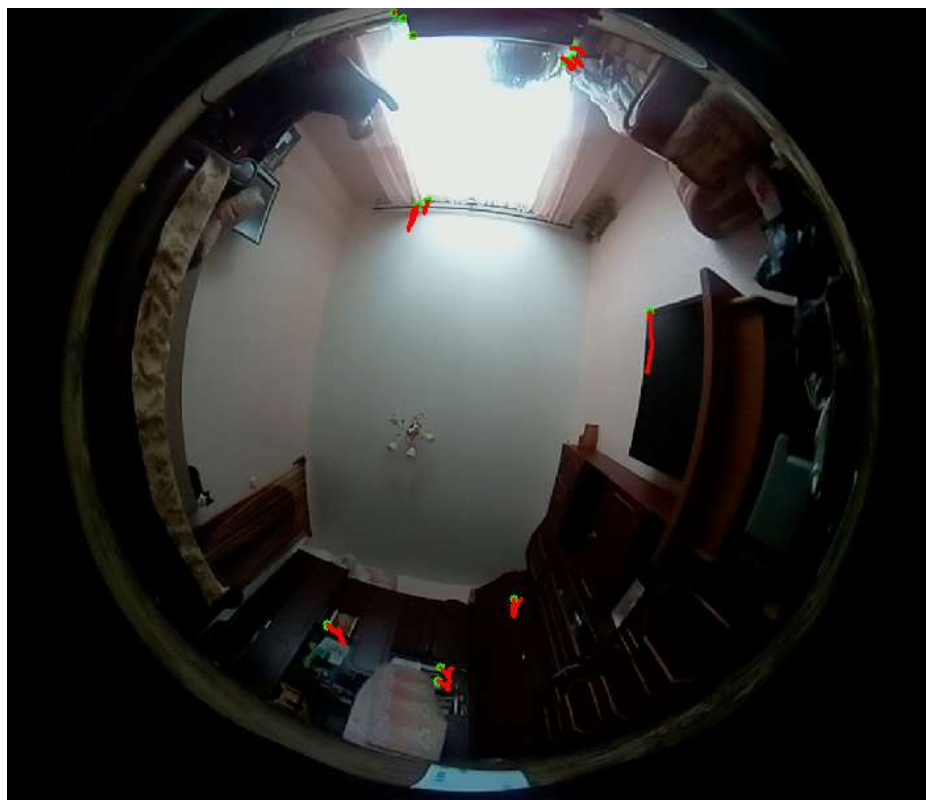
Рис. 2.14. Пример работы трекинга Лукаса-Канаде (зеленым отображены отслеживаемые точки, красным – их траектории)
