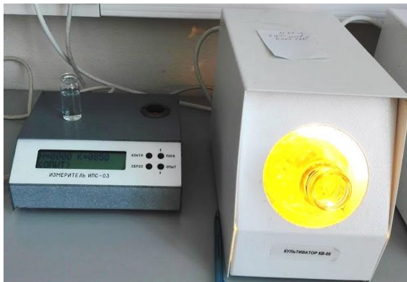
Рисунок 2.3.4.2. Приборы для культивирования микроводоросли КВ-05 и измерения оптической плотности культуры ИПС-03.
