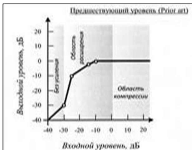
Рисунок 8. Амплитудная характеристика компрессора, предшествующий уровень
