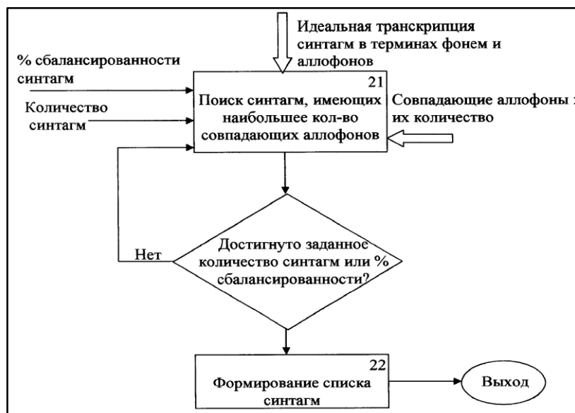
Рисунок 32. Часть блок-схемы алгоритма формирования сбалансированных синтагм
