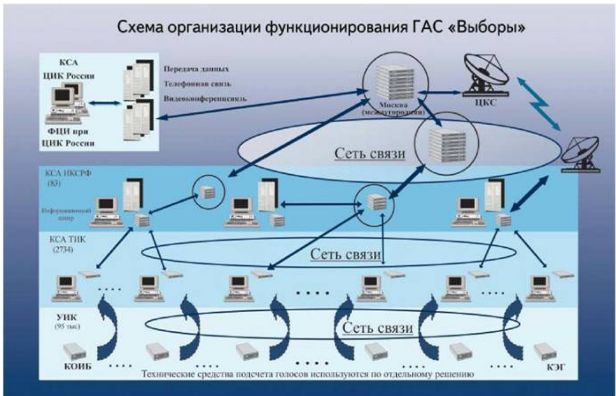
Рисунок 1.4 - Схема организации функционирования ГАС «Выборы»
