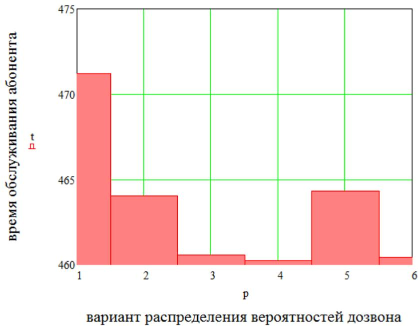
Рисунок 3.30 - График зависимости времени обслуживания абонента с вероятностью 0,95 системой-112 от варианта распределения вероятностей обратного дозвона до ложного абонента
