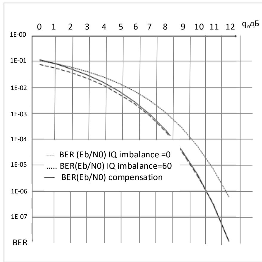
Рисунок 2.6 - Работа алгоритма компенсации для заданного угла поворота
