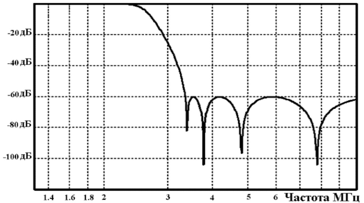
Рисунок 1.6 - Пример расчета аналогового фильтра высокого порядка в среде Filter Solutions: амплитудно-частотная характеристика
