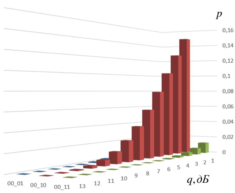
Рисунок 3.7 - Изменение зависимости распределения вероятностей символьной ошибки от степени амплитудного разбаланса
