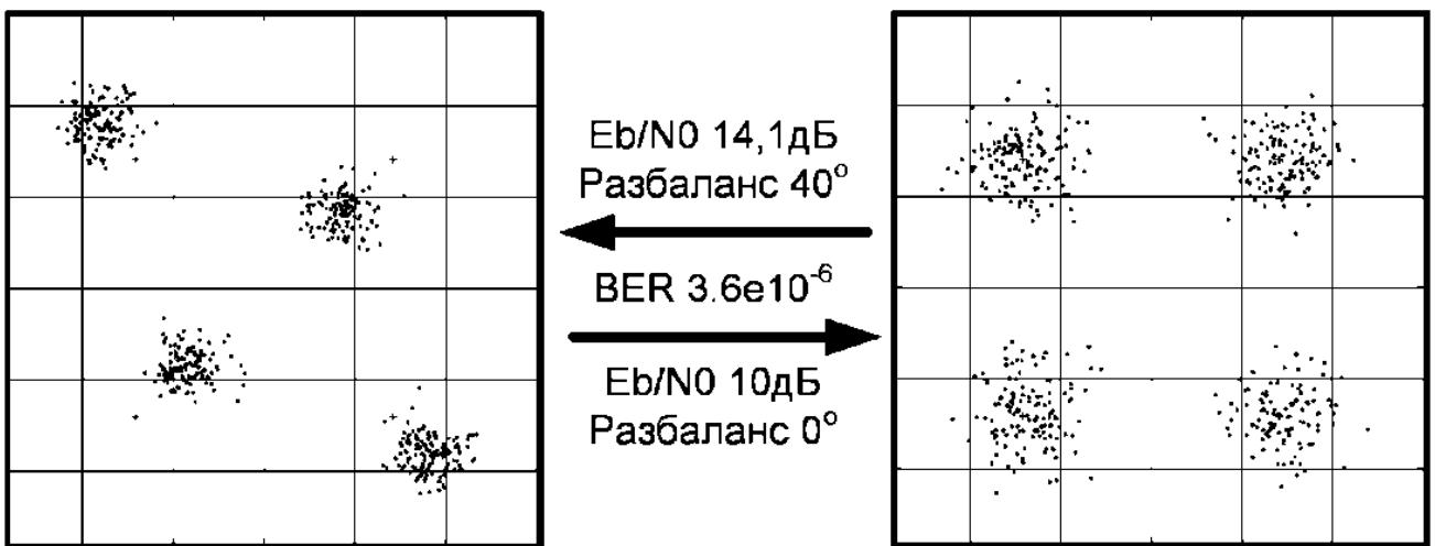
Рисунок 3.12 - Пример созвездий с одинаковым  $BER$
