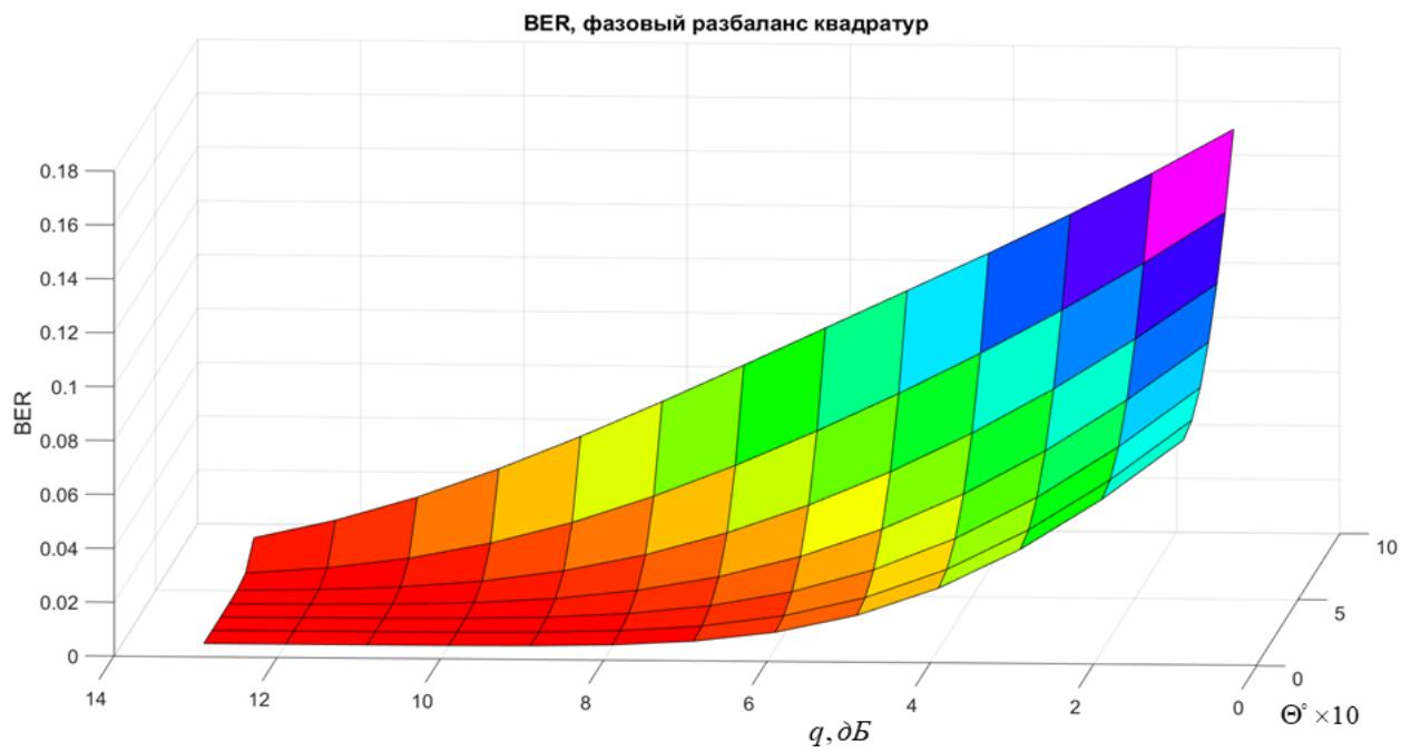
Рисунок 3.16 - Зависимость битовой ошибки от ОСШ
