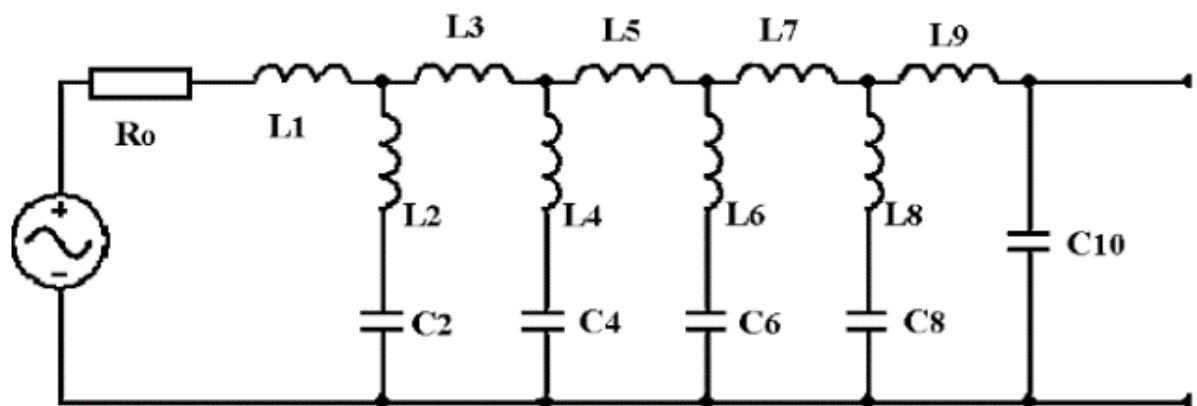
Рисунок 1.5 - Пример расчета аналогового фильтра высокого порядка в среде Filter Solutions - принципиальная электрическая схема
