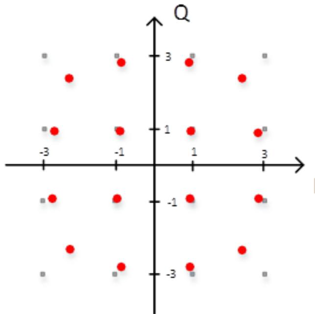
Рисунок 4.7 - Сигнальные созвездия QAM-16 на выходе модели усилителя при входной мощности 15мВт
