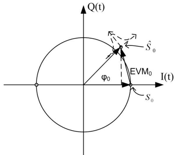
Рисунок 2.4 - Определение величины угла поворота при воздействии на него искажения, на основе использования нормированной на среднюю мощность созвездия величины вектора ошибок
