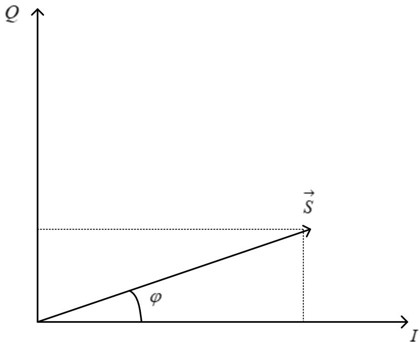
Рисунок 1.9 - Векторное отображение сигнала в квадратурных координатах
