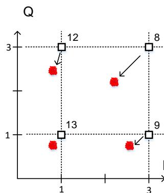
**Рисунок 4.2 - Искажение сигнального созвездия при прохождении нелинейного усилителя**
