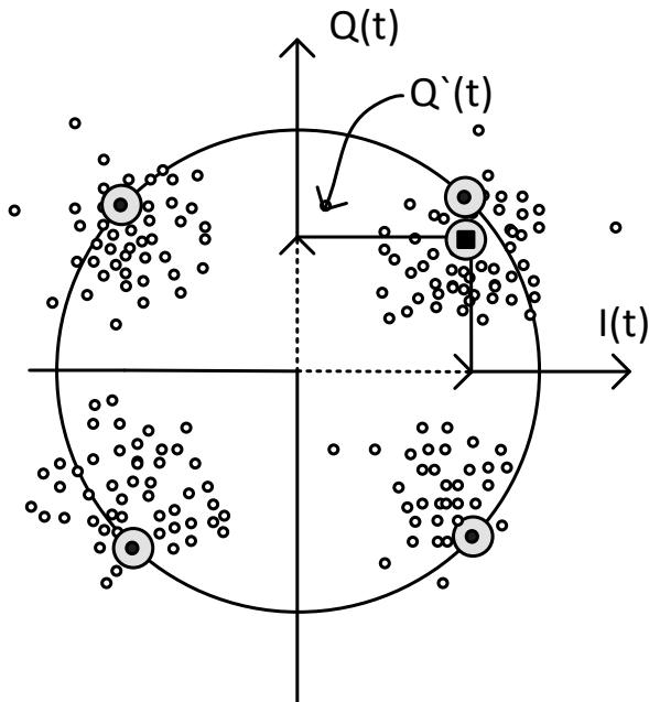
Рисунок 3.2 - Виды искажения QPSK – амплитудный разбаланс
