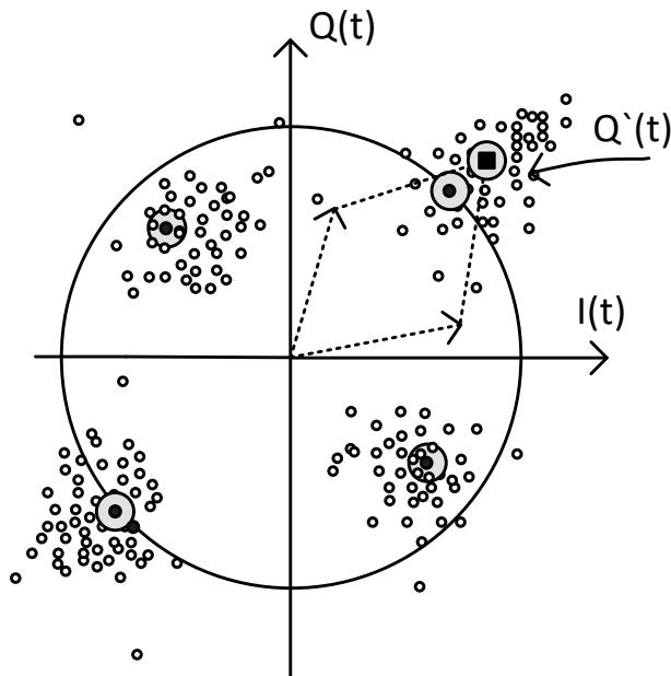
Рисунок 3.1 - Виды искажения QPSK – фазовый разбаланс
