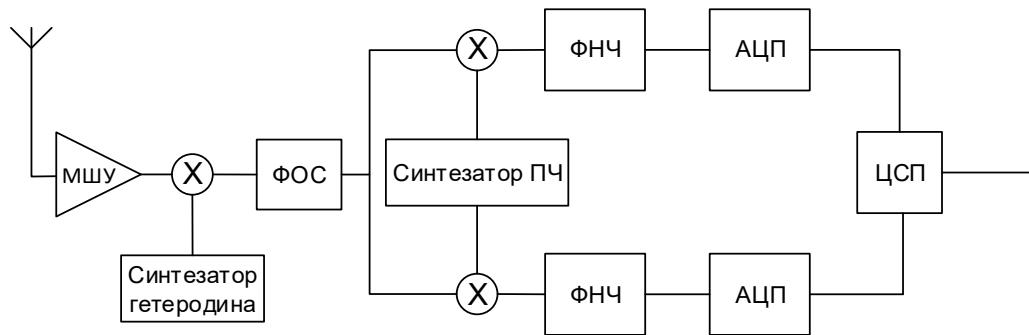
Рисунок. 1.2 - Блок-схема реализации технологии программно-определенного радио с аналоговым переносом радиосигнала на промежуточную частоту
