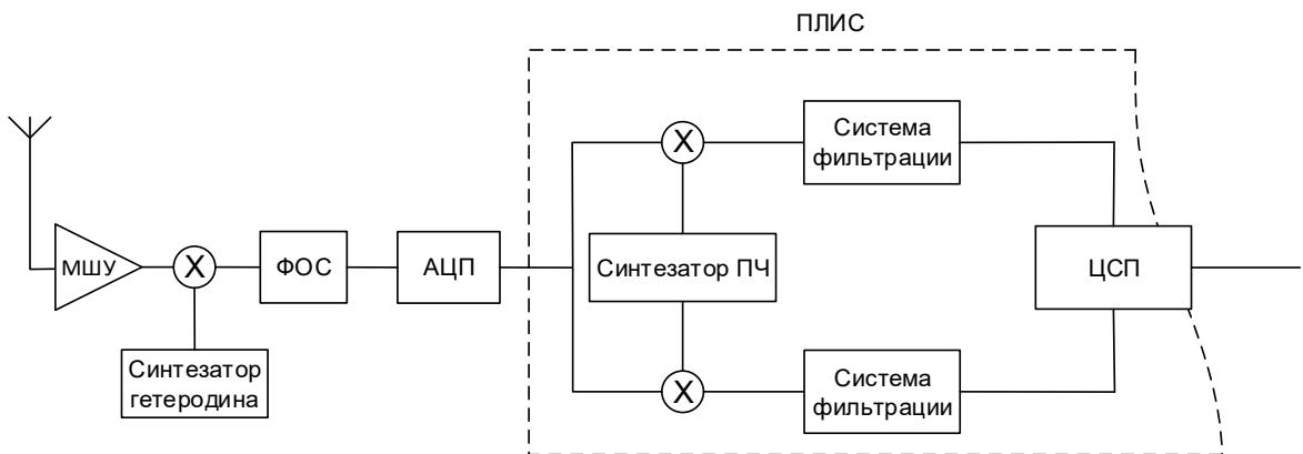
Рисунок. 1.3 - Блок-схема реализации технологии программно-определенного радио с аналоговым переносом радиосигнала на низкую частоту
