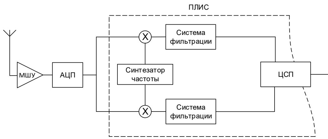
Рисунок 1.1 - Блок-схема идеальной реализации технологии программно-определенного радио
