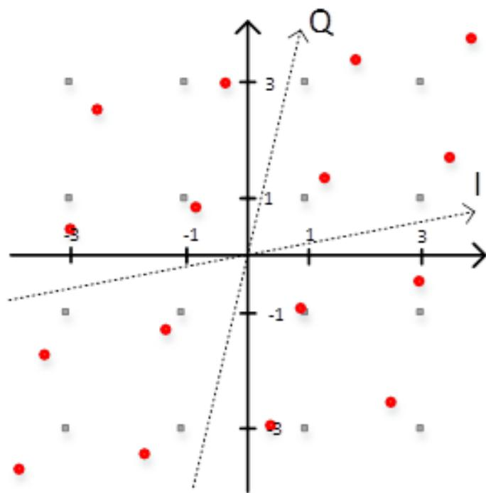
Рисунок 4.9 - Искаженные сигнальные созвездия QAM-16: фазовый разбаланс квадратур
