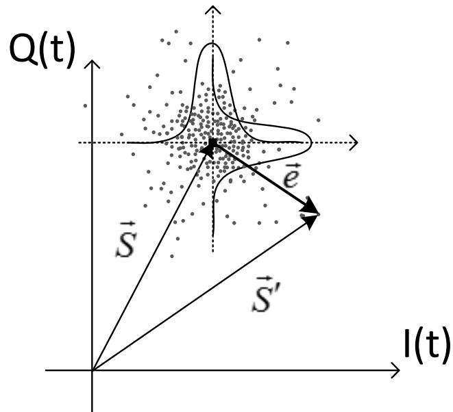
Рисунок 1.11 - Графическая интерпретация вектора ошибки при воздействии на канальный символ АБГШ
