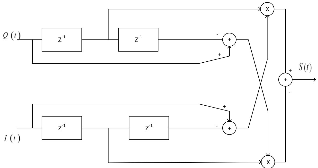
Рисунок 1.10 - Квадратурный демодулятор ЧМ сигнала
