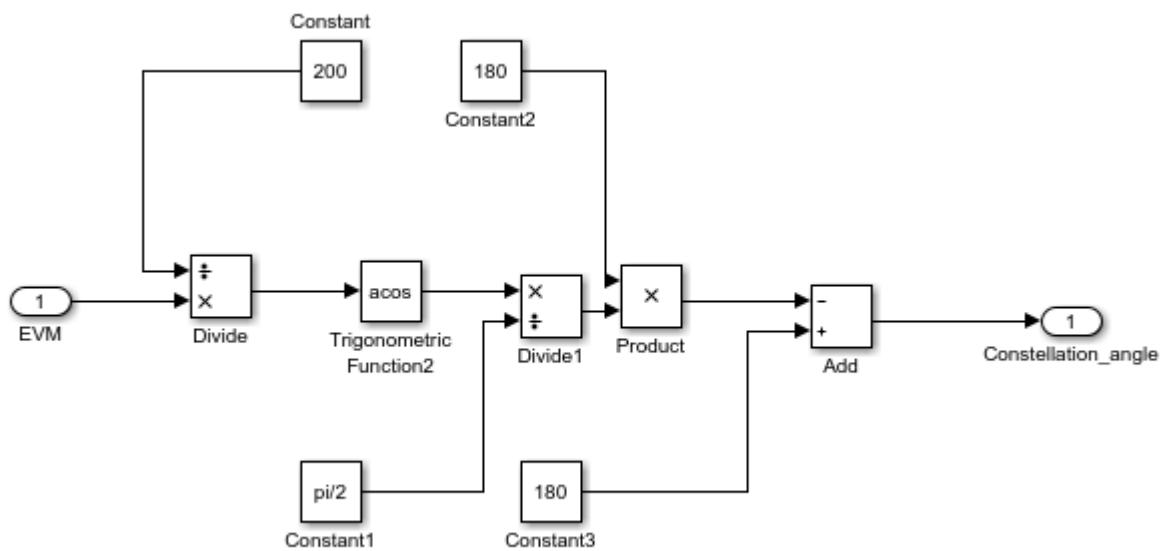
Рисунок В.2 - Фрагмент модели, реализующий вычисление угла поворота созвездия при передаче радиосигнала BPSK
