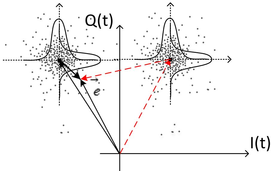
Рисунок 1.13 - Вычисление вектора ошибки неэталонным методом при ошибочном приеме канального символа под воздействием АБГШ в канале передачи информации
