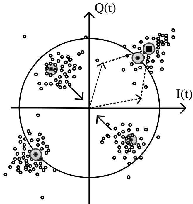
Рисунок 3.10 - Диаграмма поведения преобладающей ошибки для фазового разбаланса
