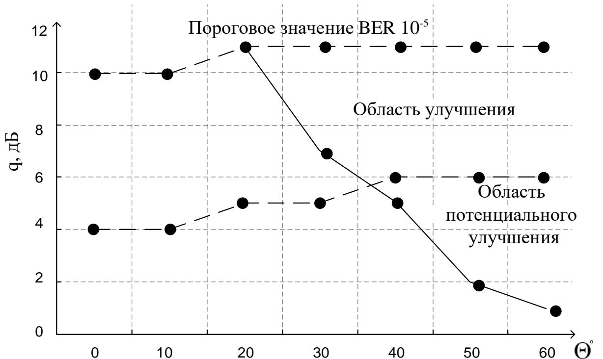
Рисунок 2.11 - Диаграмма работы алгоритма детектирования искажения и его компенсации
