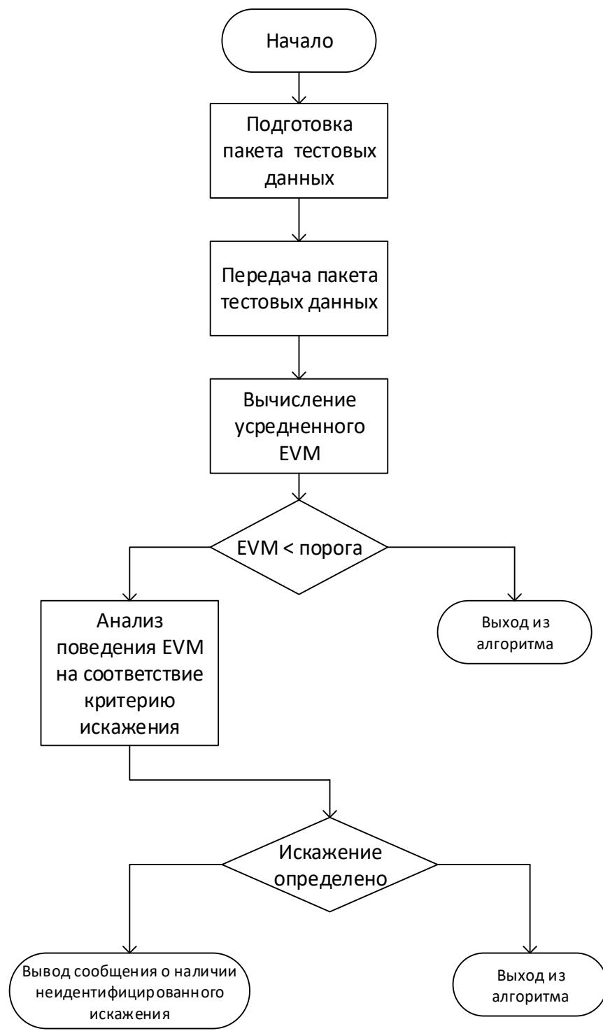
Рисунок 4.18 - Блок-схема работы системы идентификации искажений
