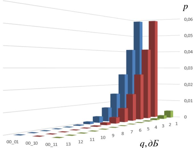
Рисунок 3.3 - Изменение зависимости распределения вероятностей символьной ошибки при передаче символа 00 от угла разбаланса
