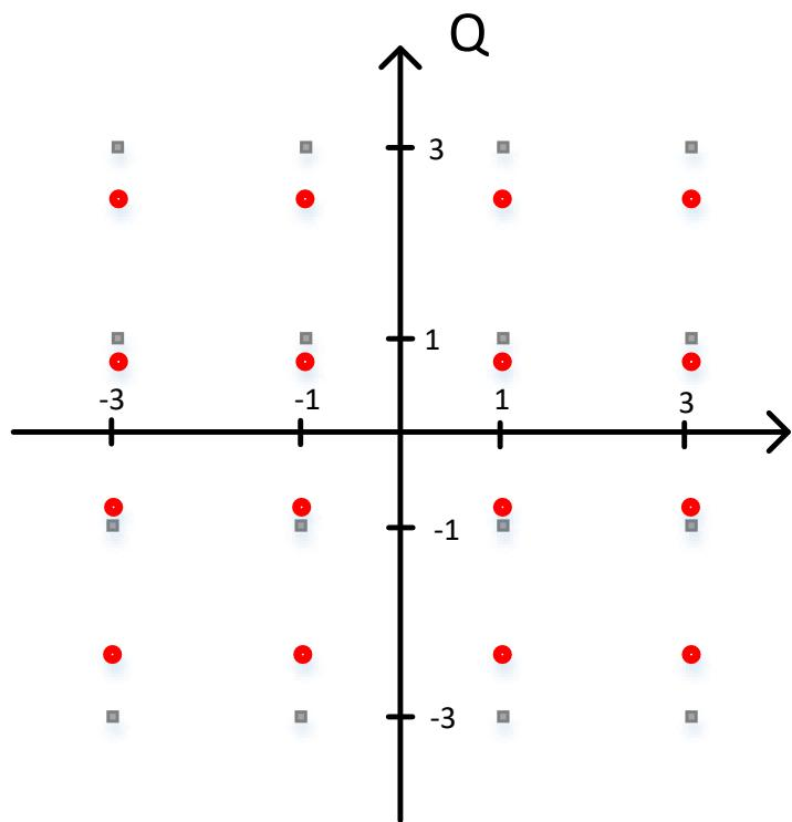
Рисунок 4.10 - Созвездие QAM-16, искаженное амплитудным разбалансом, величина вектора ошибки EVM 26%
