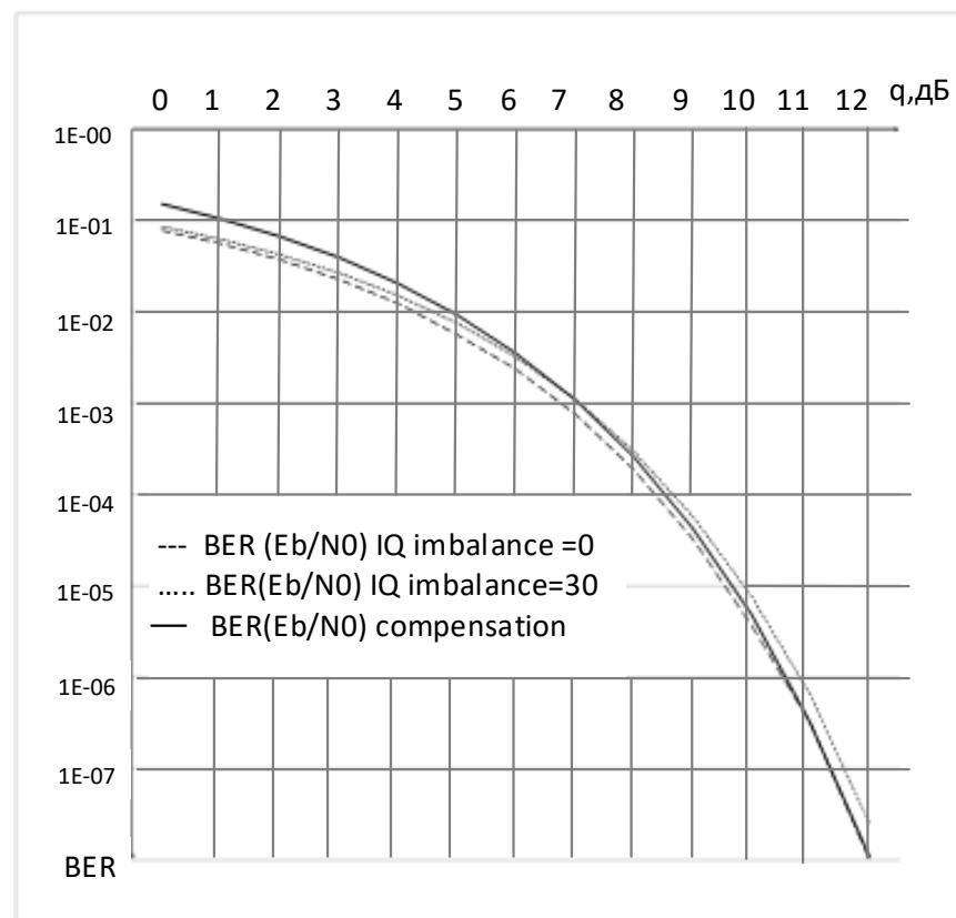
Рисунок 2.5 - Работа алгоритма компенсации для заданного угла поворота
