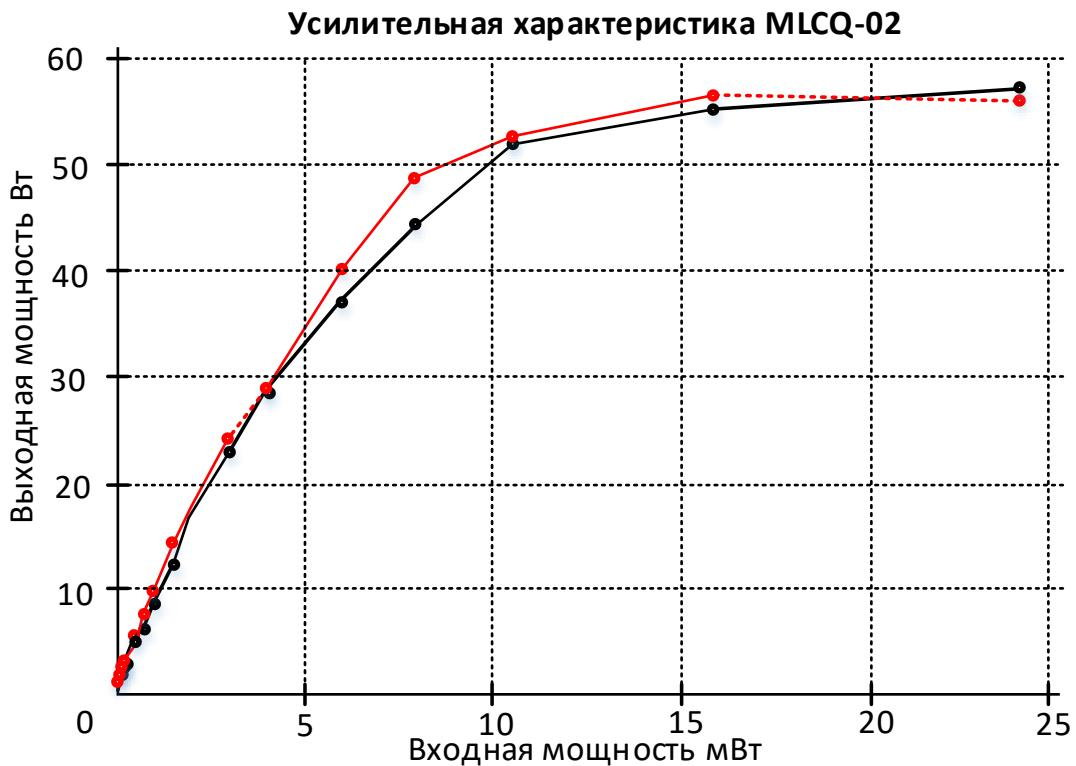
Рисунок 4.5 - Усилильная характеристика MLCQ-02 (сплошная линия), усилильная характеристика модели устройства (пунктирная линия)
