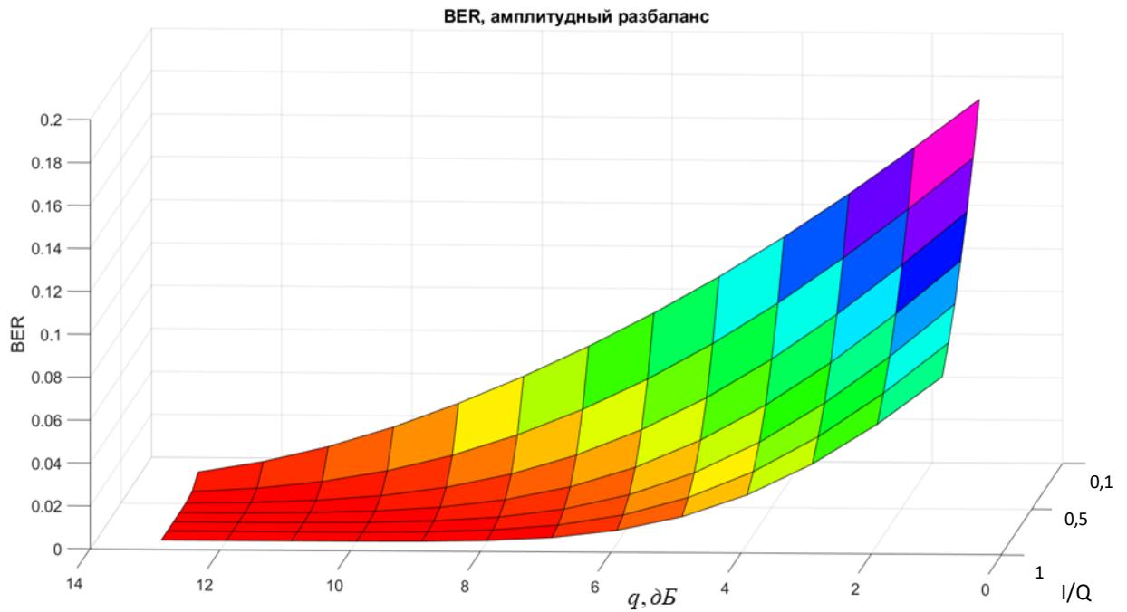
Рисунок 3.17 - Зависимость битовой ошибки от ОСШ при различных величинах разбаланса квадратур
