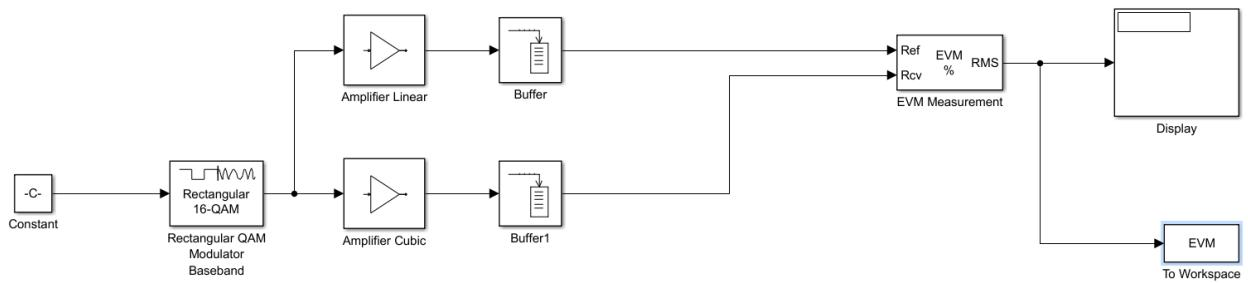
Рисунок В.1 - Модель телекоммуникационной системы, предназначенная для оценки влияния нелинейного искажения усилителя на величину вектора ошибки при передаче сигнала QAM-16
