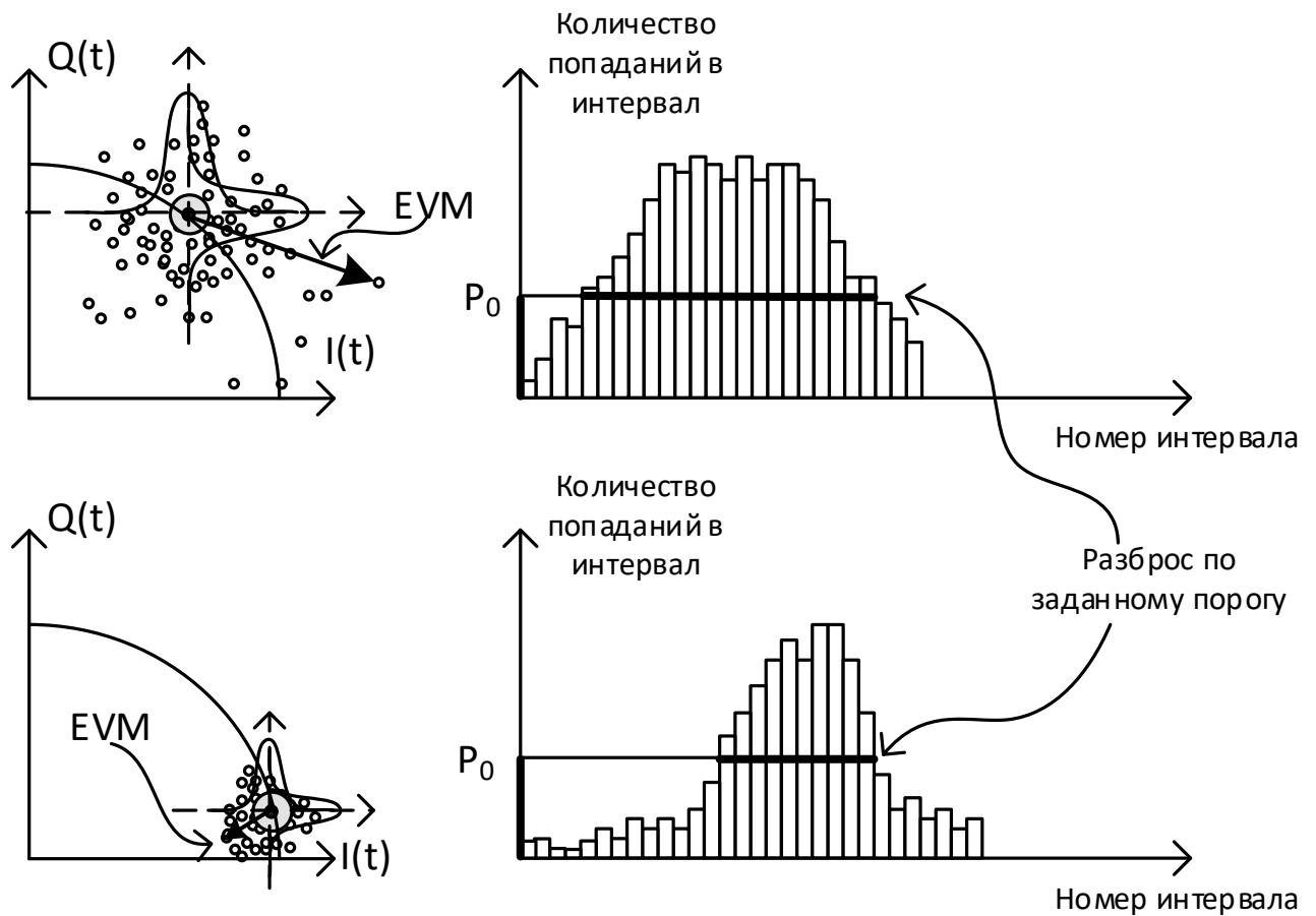
Рисунок 3.13 – Графическая иллюстрация процесса разбиения на интервалы результатов моделирования для заданного искажения и ОСШ
