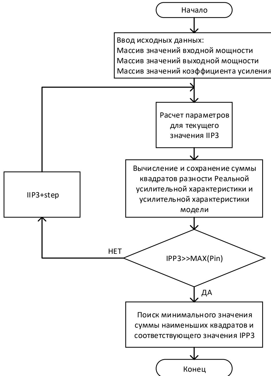
Рисунок 4.4 – Блок-схема алгоритма расчета аппроксимированной усилительной характеристики
