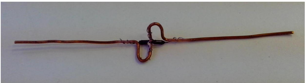
Рис. 3.2. ПР в виде диполя, нагруженного на два, последовательно включенных параметрических контура, образованных полупроводниковым диодом и проволочной индуктивностью в виде дужки
