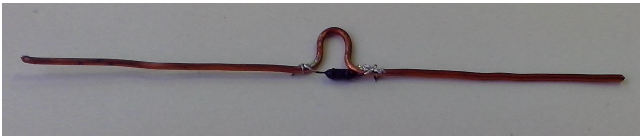
Рис. 3.1. ПР в виде диполя, нагруженного на одиночный параметрический контур, образованный полупроводниковым диодом и проволочной индуктивностью в виде дужки
