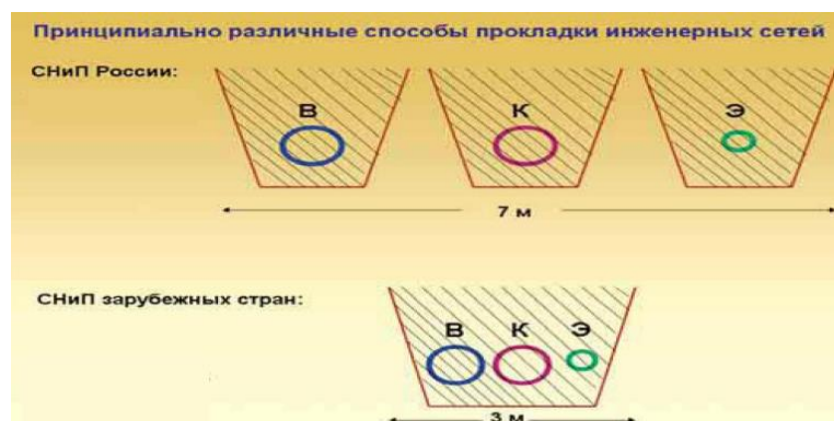
Рисунок 1.14. Различные способы прокладки коммуникаций
