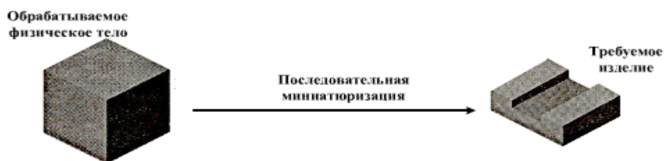
Рисунок 1.1 - Формирования наноструктур «сверху-вниз»
