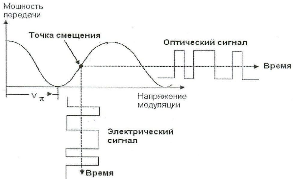
Рисунок 3.2 - Модуляционная характеристика МЦМ
