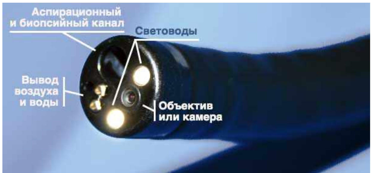
Рисунок 1.2 – Устройство дистальной части видеоэндоскопа
