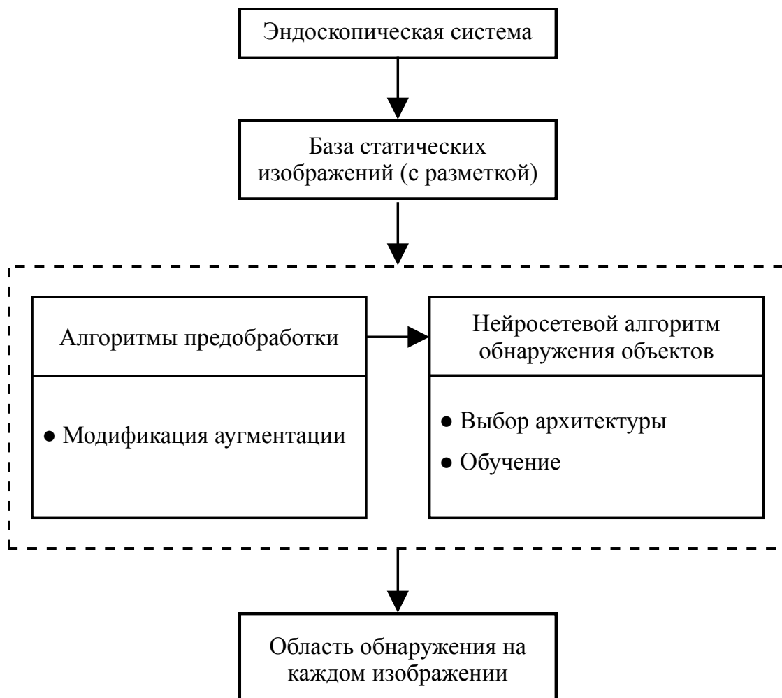
Рисунок 2.12 – Структурная схема разработки алгоритма обнаружения полипов на эндоскопических изображениях кишечника
