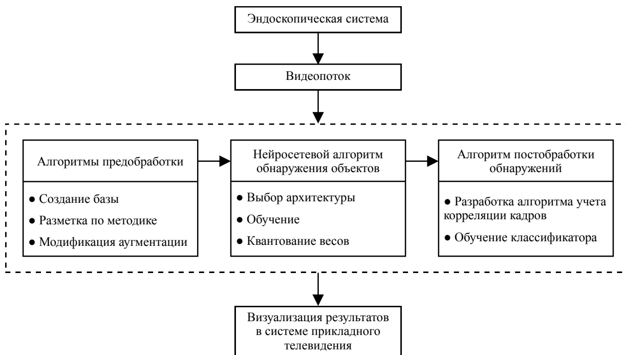
Рисунок 3.12 – Структурная схема разработки алгоритма обнаружения объектов в видеопотоке с эндоскопической системы
