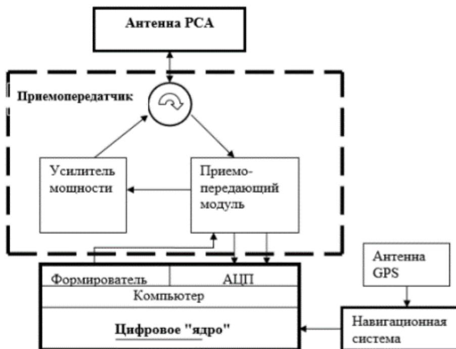
Рисунок 1.6 – Структурная схема подсистемы РС «Компакт» [30]
