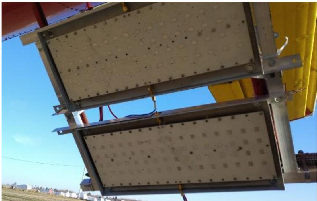
Рисунок 4.13 – Установка блока антенн на самолет
