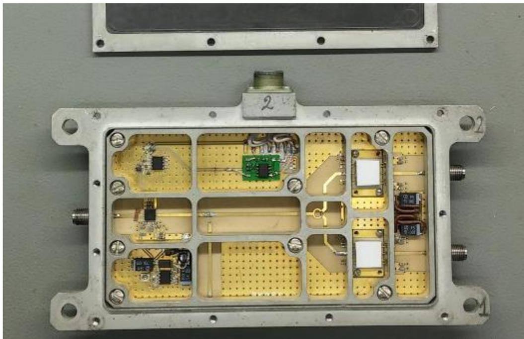
Рисунок 4.9 – Блок усилителя мощности X-диапазона частот
