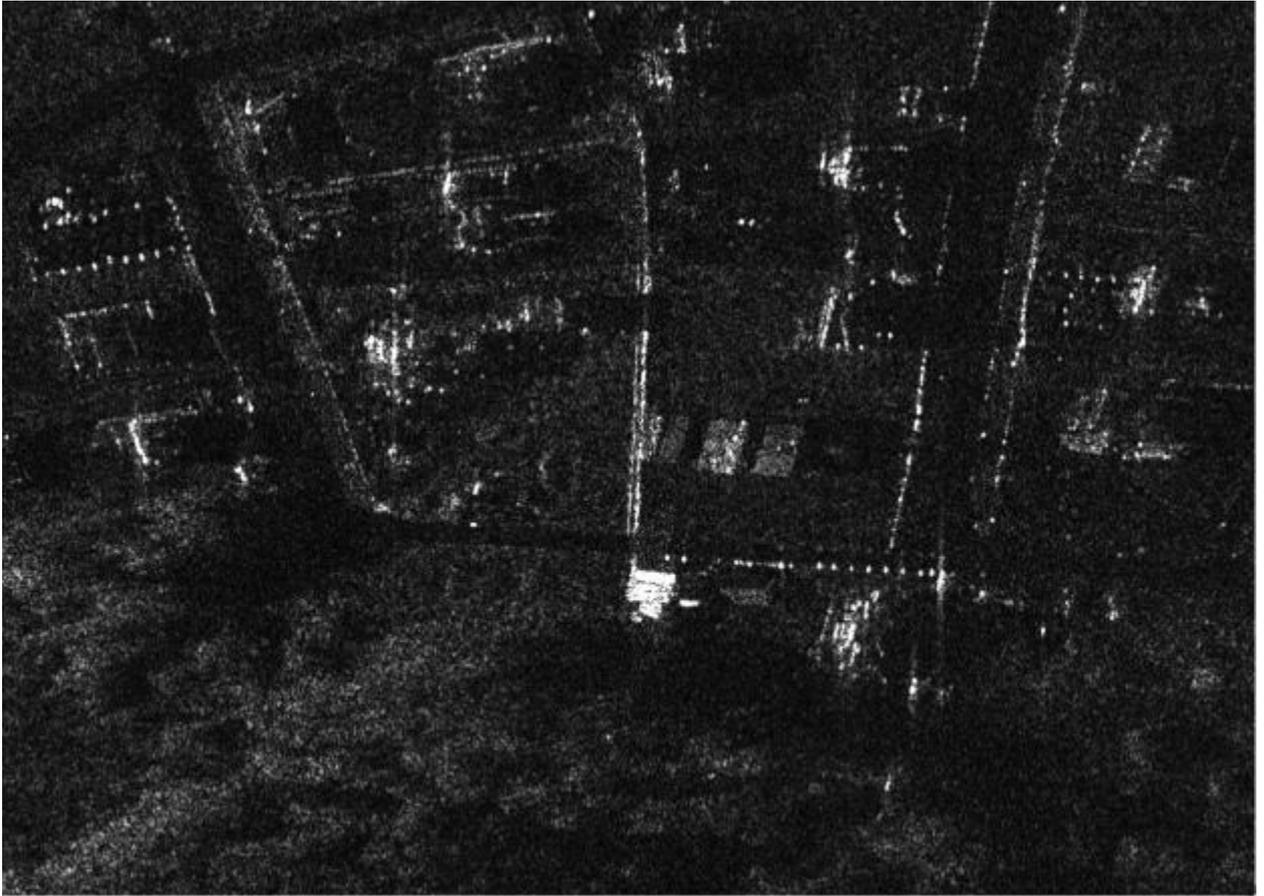
Рисунок 4.19 – Изображение местности при широкополосном импульсе
