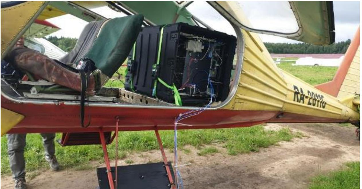
Рисунок 4.12 – Установка СИМ в самолет
