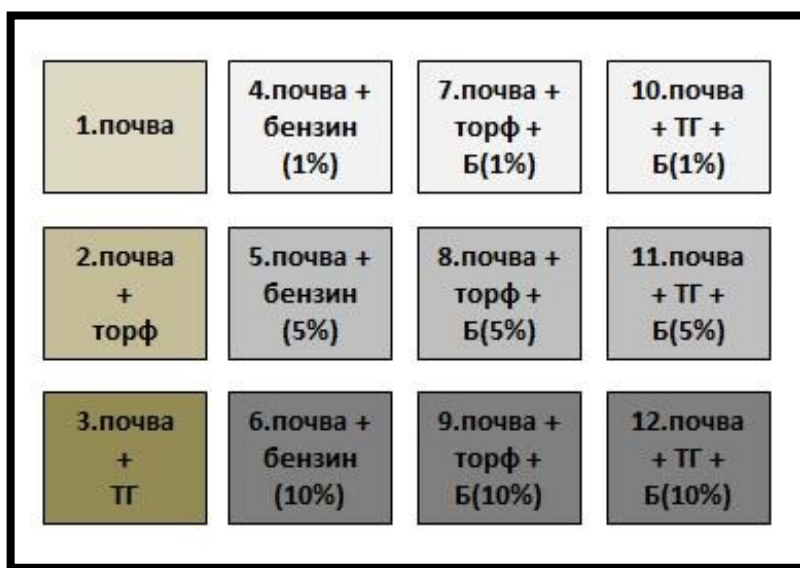
Рисунок 5 – Схема модельного эксперимента по влиянию бензина (Б) на свойства почвы и определению ремедиационного потенциала торфа и торфогеля (ТГ)
