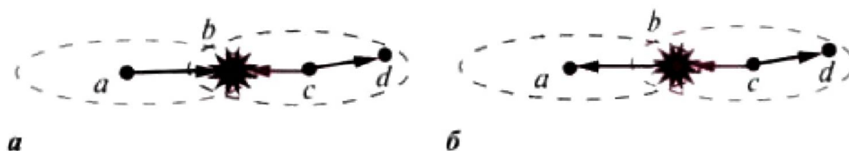
Рис. 3.1.2. Иллюстрация проблем «скрытого» (а) и «открытого» (б) терминалов
