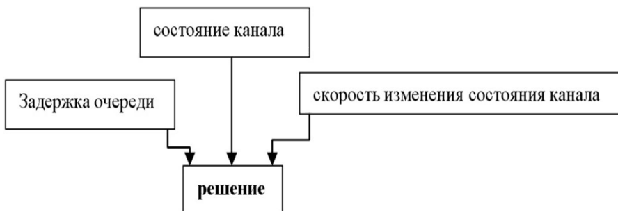
Рис.3.2.2. Схема нечеткого управления доступом
