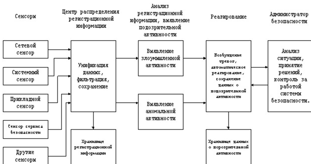
Рис.1.5. Основные элементы архитектуры систем обнаружения вторжений
