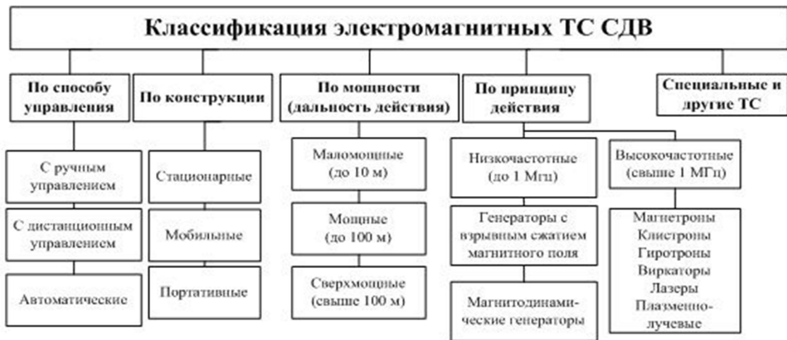
Рис.2.2.2. Классификация ТС СДВ по эфиру (электромагнитные ТС СДВ)
