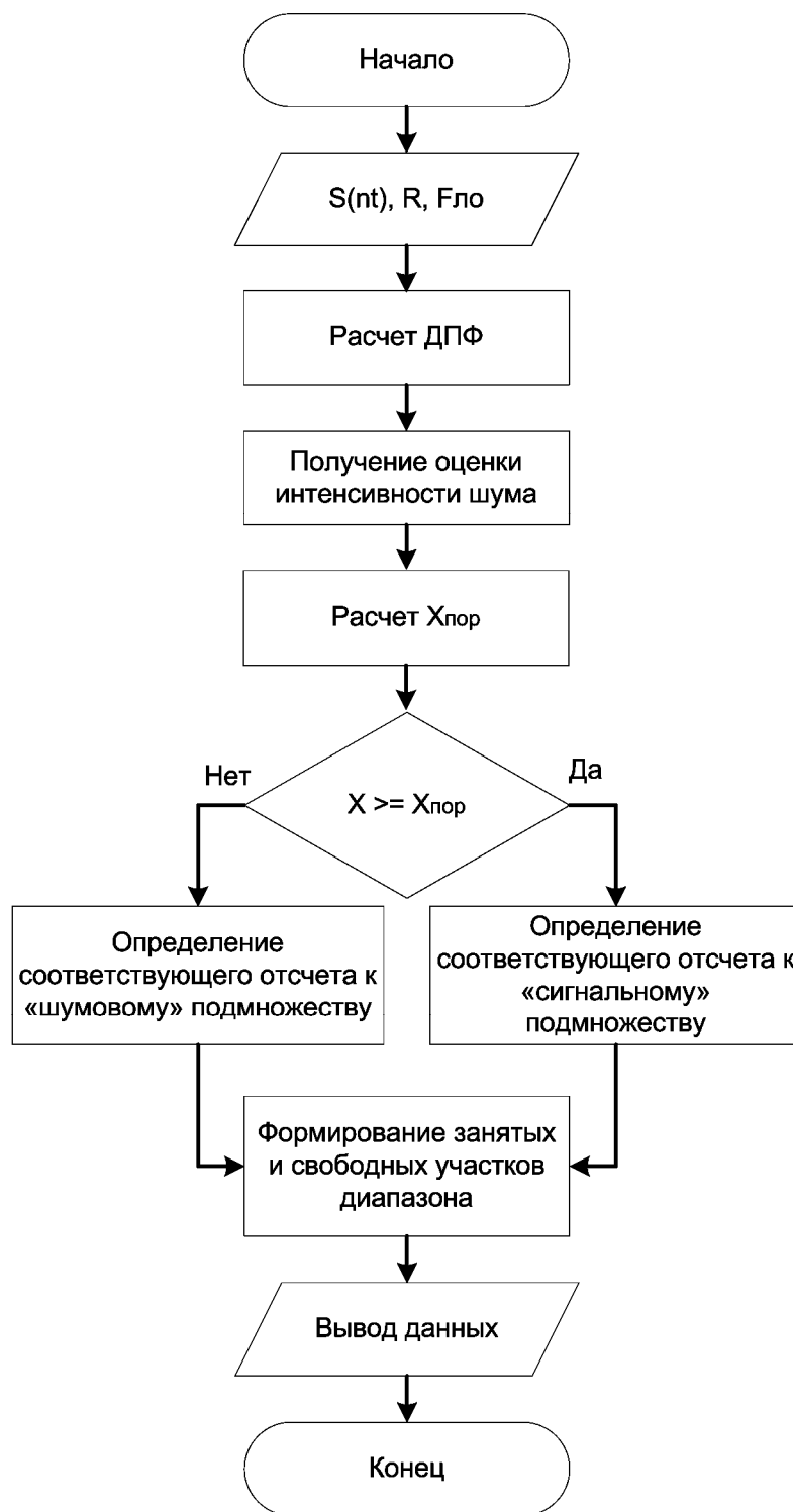
Рис. 2.12. Блок-схема реализации параметрического алгоритма (1.13)
