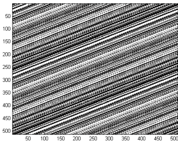
Рисунок 3.13. Модель сигнала. М-последовательность №1, длина 255, линейный циклический сдвиг
