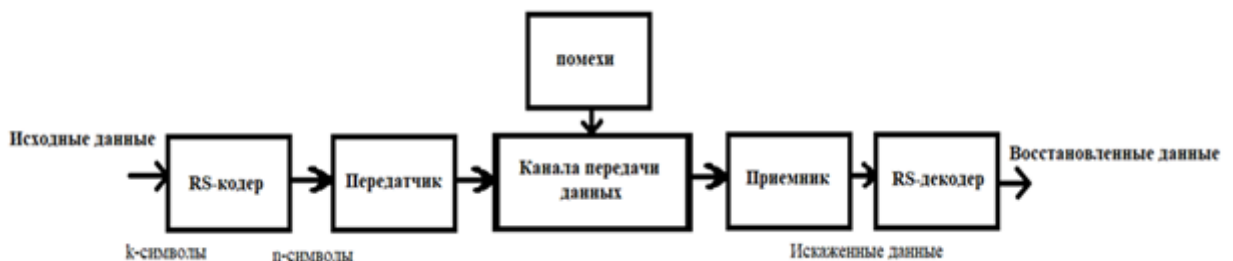
Рис. 3. Схема применения кода Рида-Соломона.
