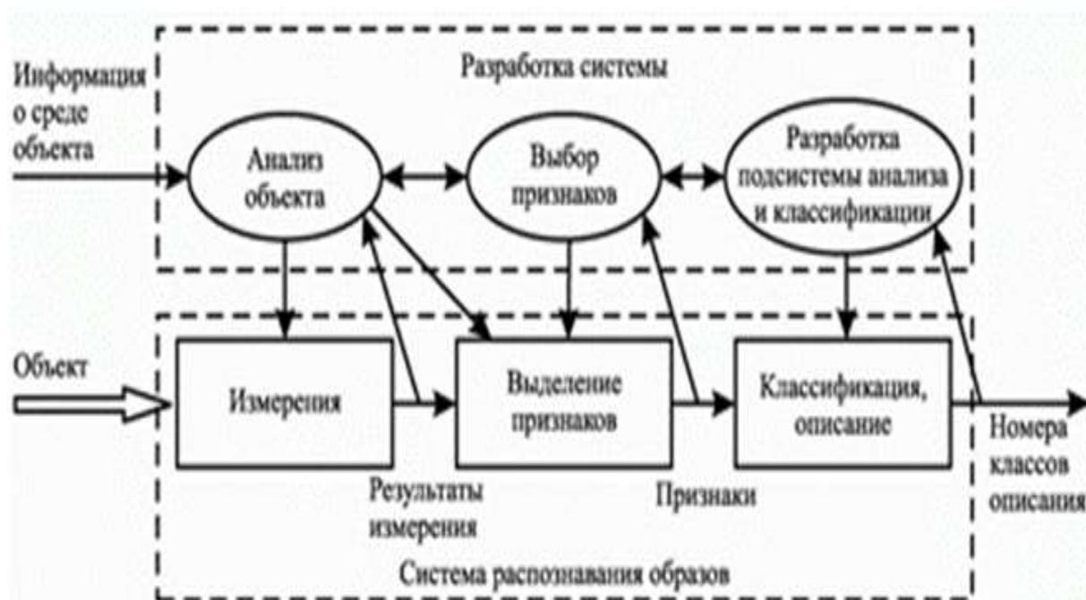
Рисунок 1.1 - Структурная схема системы распознавания образов.
