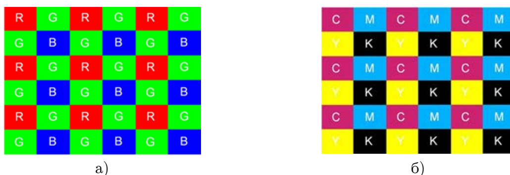
Рис. 1.2. Цветовой шаблон CFA: а) в цветовом пространстве RGB; б) в цветовом пространстве CMYK
