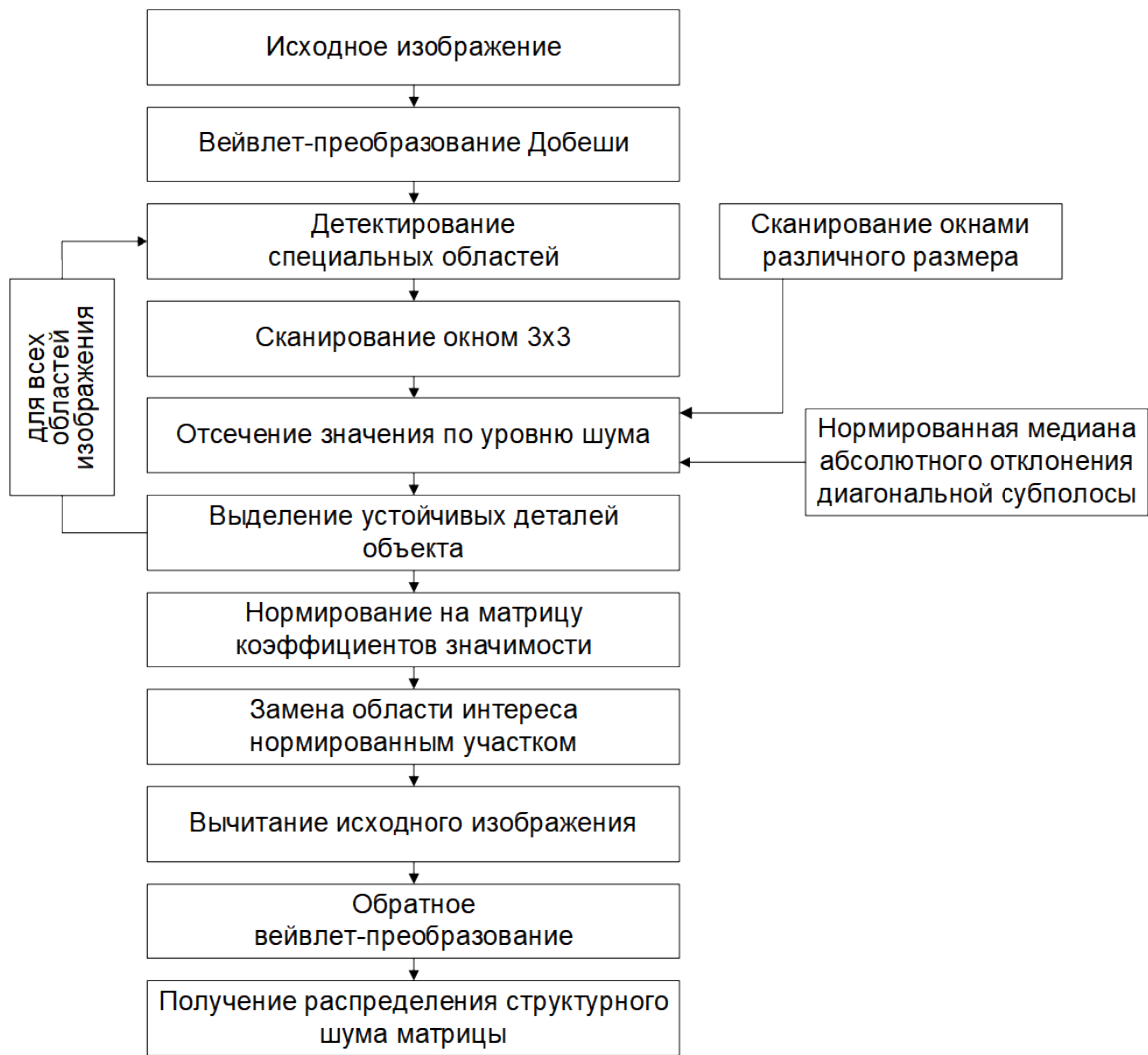
Рис. 2.4. Схема алгоритма детектирования собственного признака цифрового устройства
