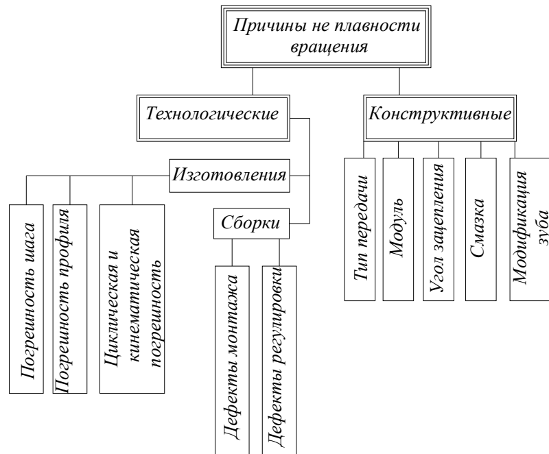
Рисунок 1.8 – Причины не плавности вращения редуктора
