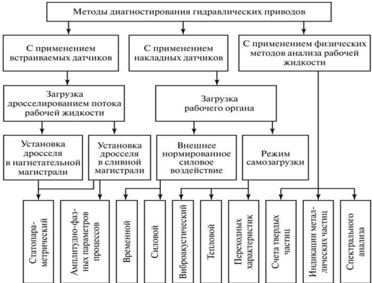
Рисунок 1.20 – Методы технического диагностирования гидроприводов МПКС
