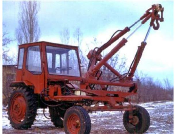
Рисунок 1.13 – Механизм параллельной структуры в качестве навесного оборудования для сельскохозяйственной техники
