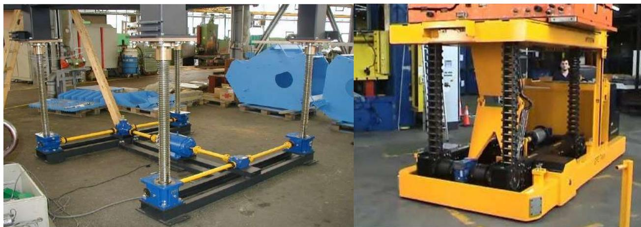
Рисунок 1.8 – Подъемный стол на основе винтовых домкратов
