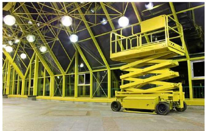
Рисунок 1.6 – Ножничная подъемная платформа
