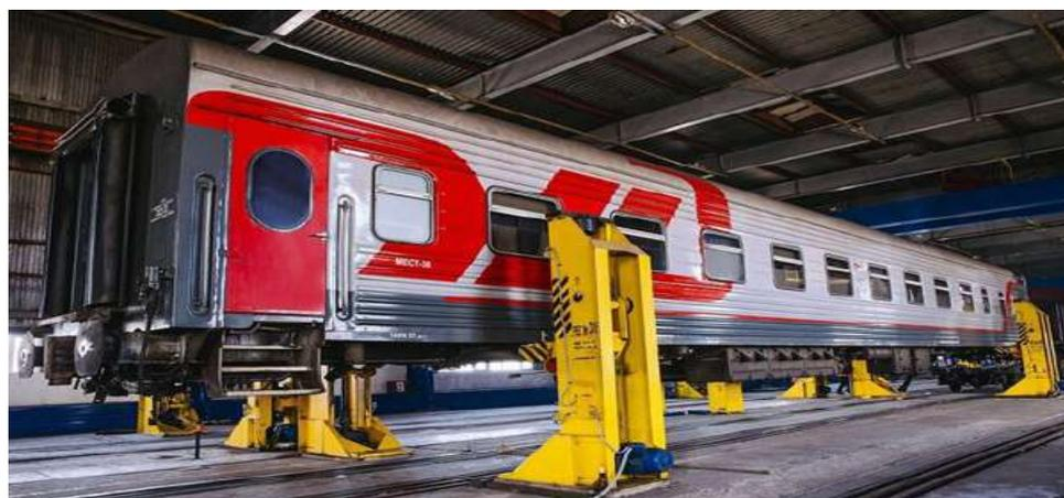
Рисунок 1.4 – Подъем вагона с помощью системы электромеханических путевых домкратов
