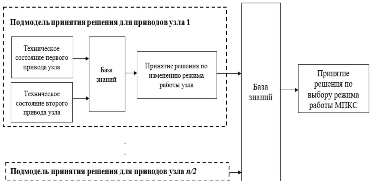
Рисунок 5.25 – Структура нечеткой модели принятия решения по выбору режима эксплуатации системы приводов МПКС со сходящимися кинематическими цепями
