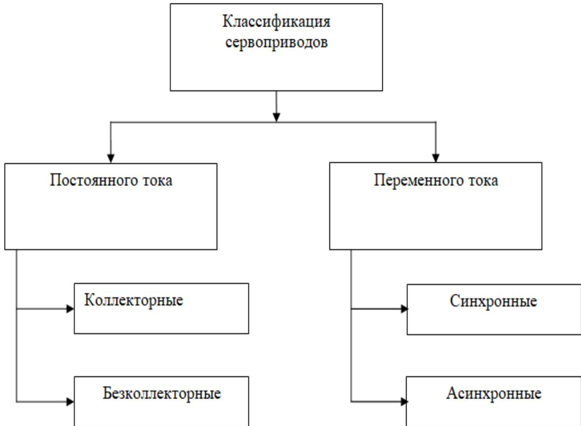
Рисунок 1.16 – Классификация сервоприводов
