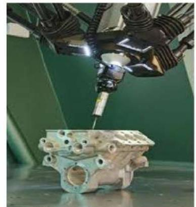
Рисунок 1.15 – Параллельный механизм для измерения координат
