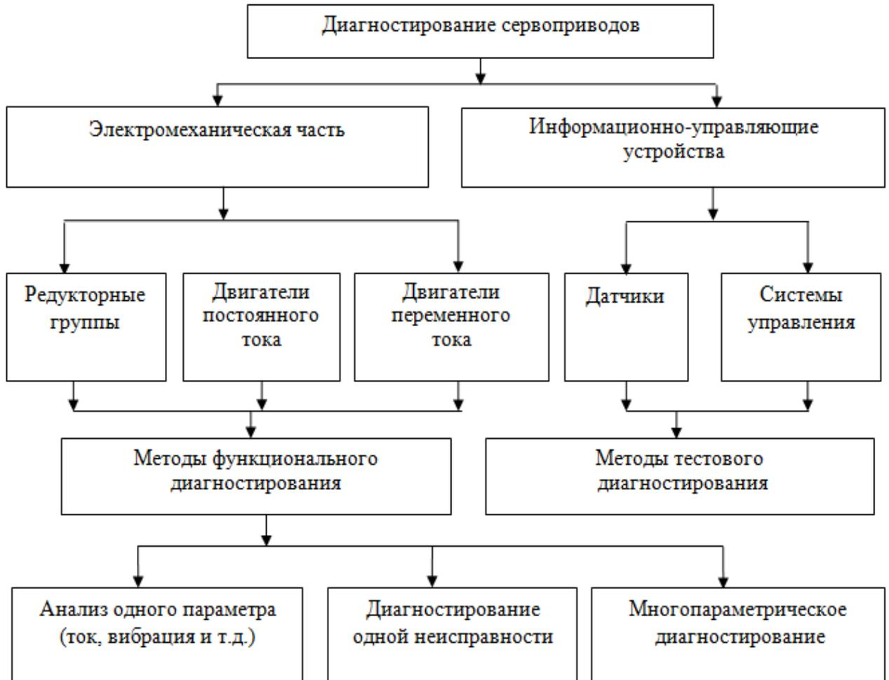
Рисунок 1.18 – Классификация методов и средств технического диагностирования электрических сервоприводов
