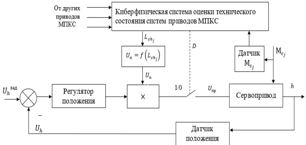
Рисунок 5.32 – Модернизированная локальная система управления приводом звена МПКС с коррекцией внешней нагрузки
