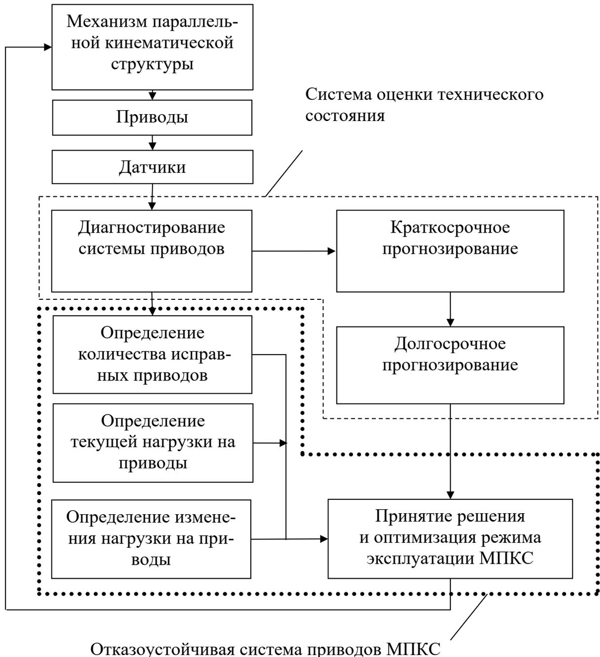
Рисунок 3.7 – Функциональная схема отказоустойчивой системы приводов МПКС
