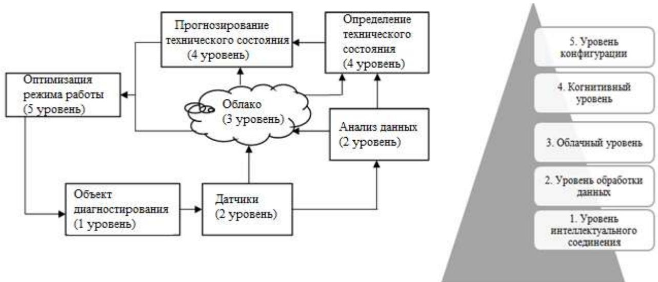
Рисунок 3.3 – Архитектура системы оценки технического состояния исполнительных приводов МПКС
