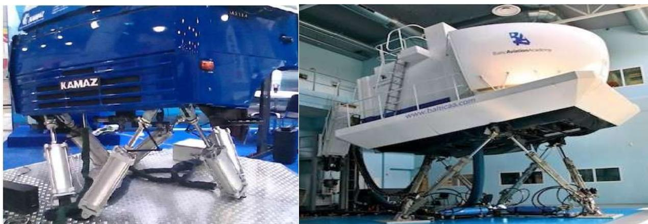
Рисунок 1.11 – Тренажеры на базе механизмов параллельной кинематической структуры
