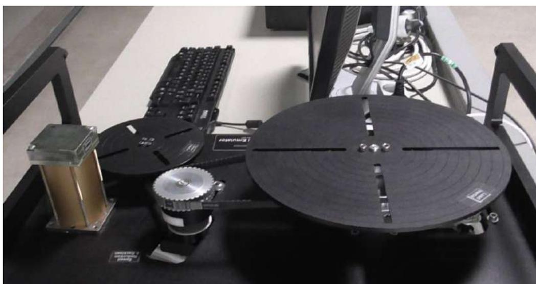
Рисунок 4.2 – Лабораторная установка для исследования электроприводов под нагрузкой
