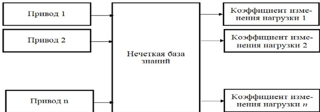
Рисунок 5.16 – Структура нечеткой модели расчета коэффициента изменения нагрузки
