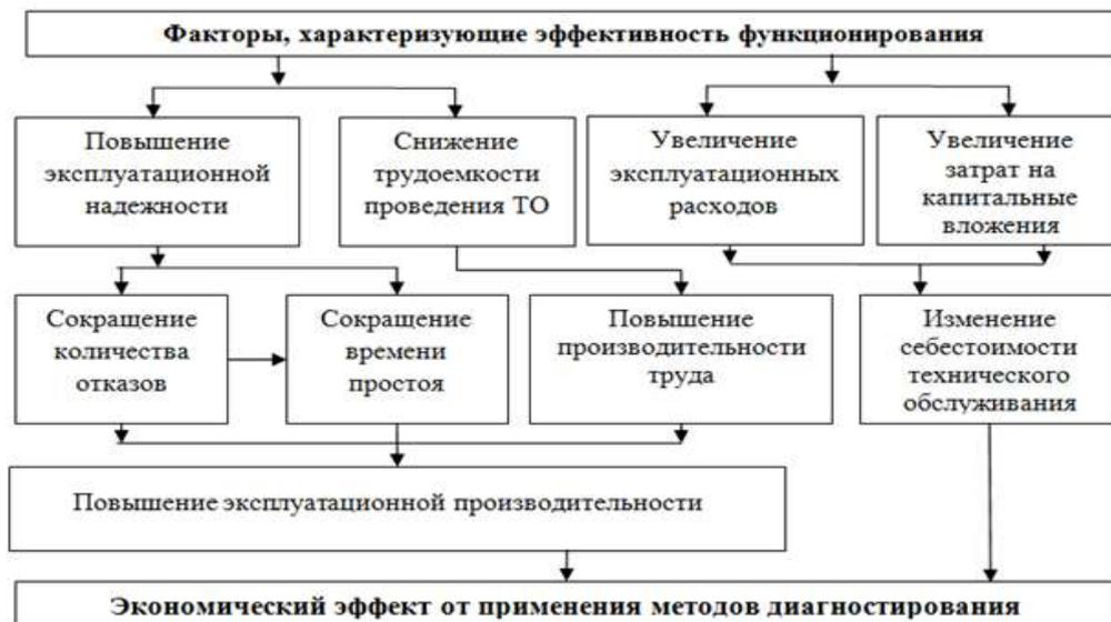
Рисунок 7.21 – Факторы, влияющие на эффективность оценки технического состояния системы приводов МПКС
