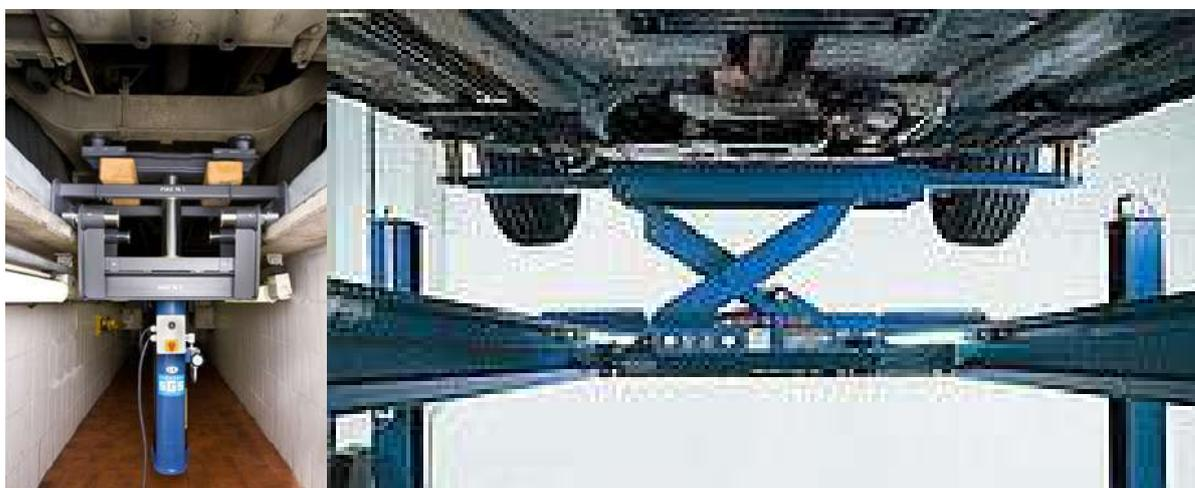
Рисунок 1.3 – Подъемники канавные гидравлические домкраты
