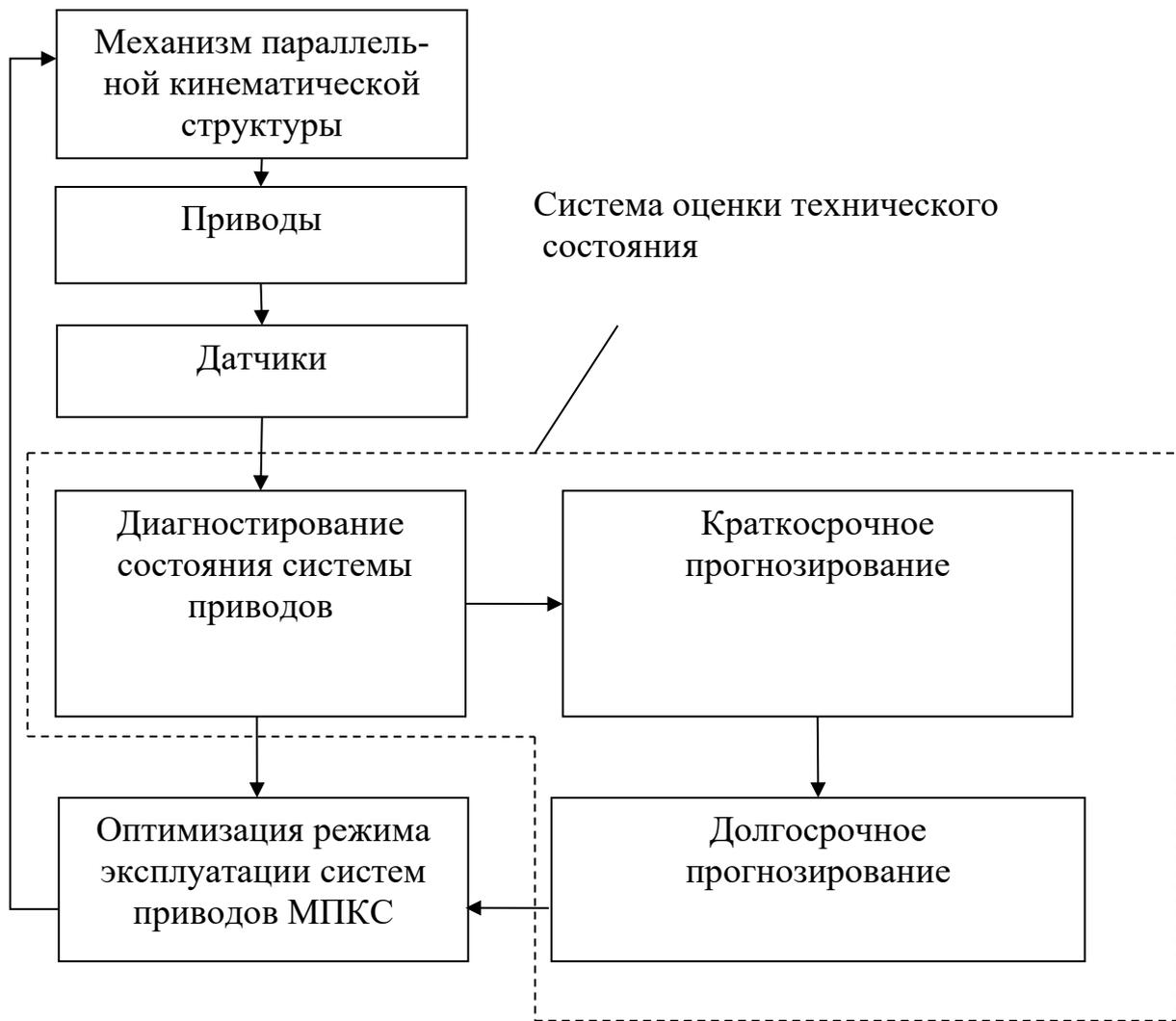
Рисунок 3.6 – Структура системы оценки технического состояния систем приводов МПКС
