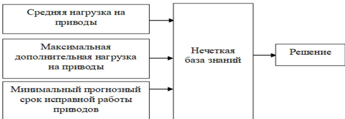
Рисунок 5.23 – Структура интеллектуальной модели принятия решения для МПКС с параллельными кинематическими цепями
