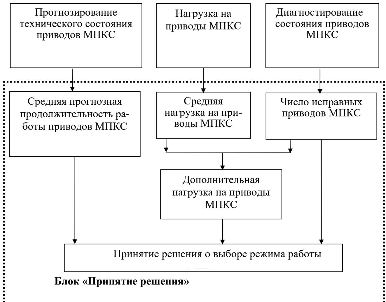
Рисунок 6.3 – Блок-схема отказоустойчивых МПКС с учетом технического состояния системы их приводов
