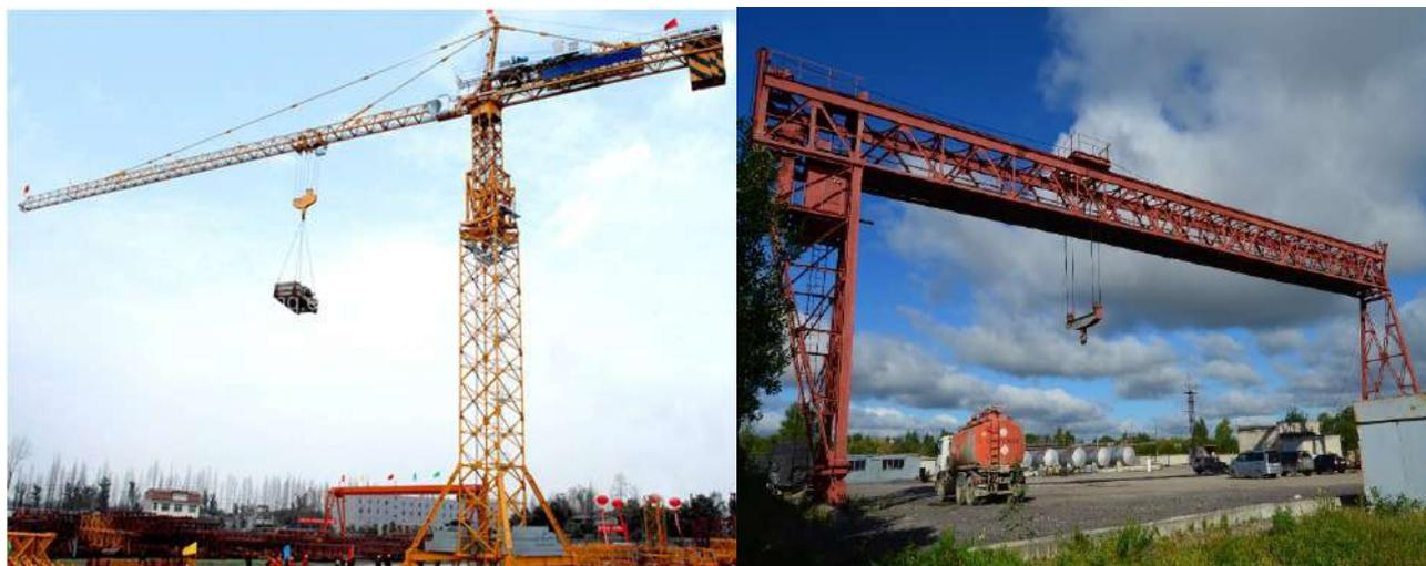
Рисунок 1.2 – Башенный и козловой подъемные краны
